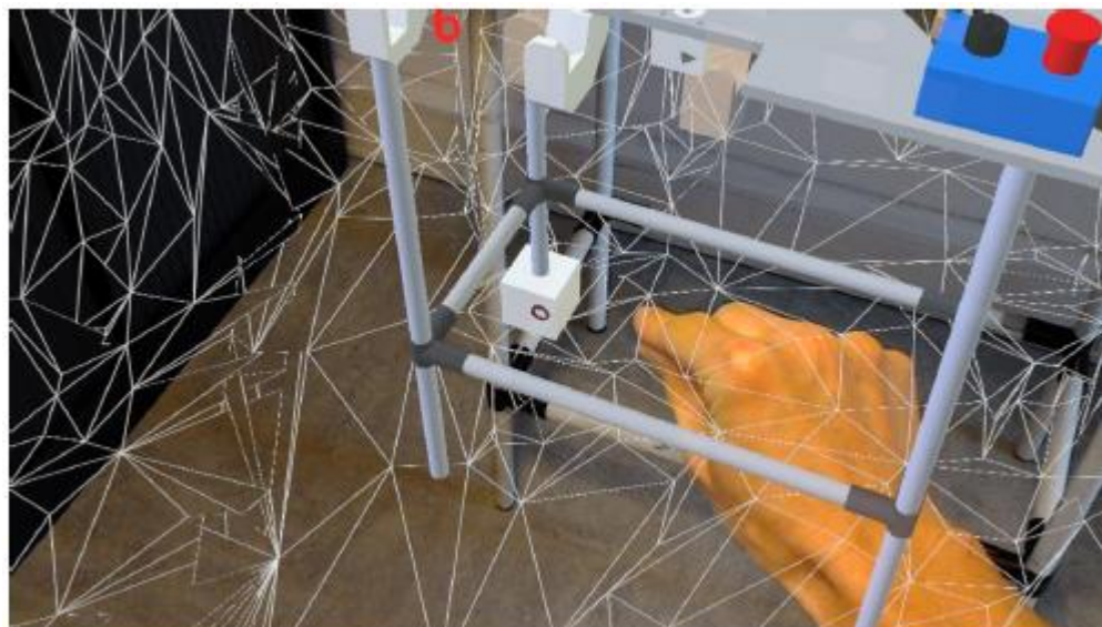
Figure 27: Calibration d'un modèle CAO d'un poste de travail sur son jumeau réel.
