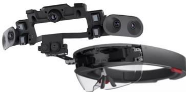
Figure 18: La fonction Captation de l'Hololens 1. Documentation Microsoft.
