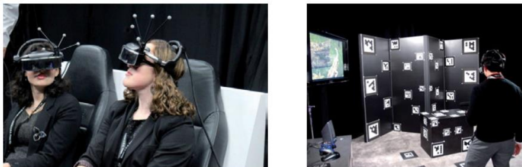
Figure 22: (a) Un système de RA Outside-In à gauche. On perçoit les constellations de perception du dispositif par les capteurs externes. (b) A droite, un système de RA Inside-Out . La méthode de suivi est basée sur des marqueurs. D'après (Mallem and Roussel, 2019).
