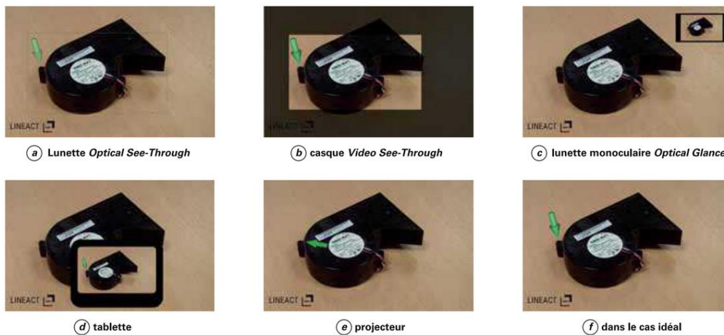
Figure 33: Différents types de rendu visuel en fonction de l'architecture de restitution du dispositif de RA. D'après (Havard, 2018; Havard and Baudry, 2019).
