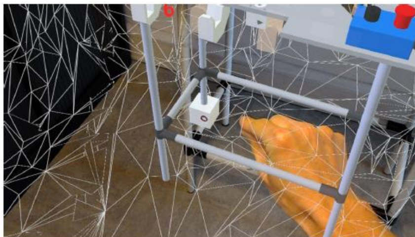
Figure 101: L'étape de calibration dans l'IHM. Ici, les interactions sont fournies par le visiocasque Microsoft Hololens 1ère génération.
