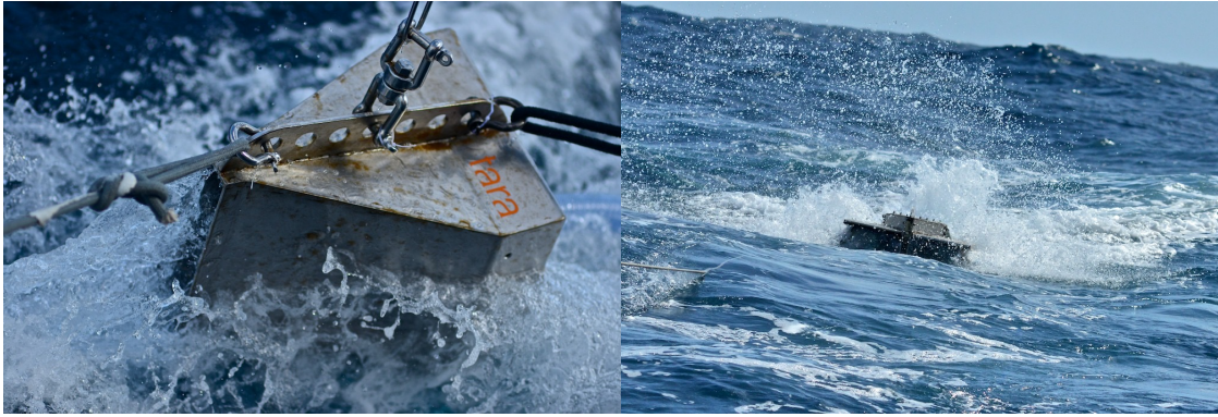
Figure 37. De gauche à droite, le HSN et le Dolphin. Prototypes bâtis pour l'échantillonnage à grande vitesse.
