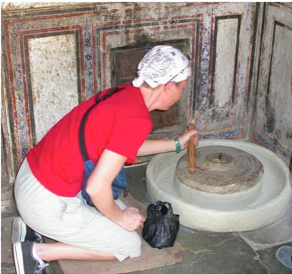
FIG. 4-3.3B – Moulin à lentilles dans l'Inde actuelle ; le moulin est inséré dans un « flour catcher » (réceptacle à farine) -source : [www.ulkie.free.fr/Inde/photos/DSCN2645ter.jpg](http://www.ulkie.free.fr/Inde/photos/DSCN2645ter.jpg)
