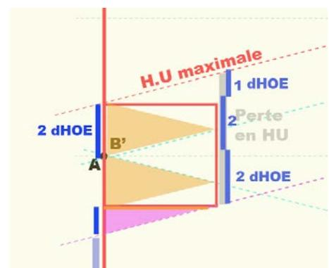
En résumé, la perte de Hauteur Utile pour l'emmanchement situé à mi-hauteur d'un *Catillus* de modèle D.24 dgt x H.12 et de conicité 14° s'établit comme suit :
