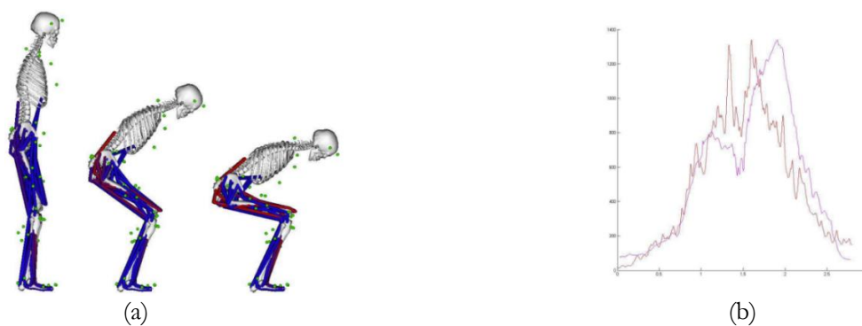
Figure 9-2 : (a) Visualisation des activations musculaires pendant un mouvement d'accroupissement (du bleu : au repos, au rouge : active). (b) Signal EMG filtré (rouge) et activation musculaire calculée (violet) pour le muscle vastus medialis .
