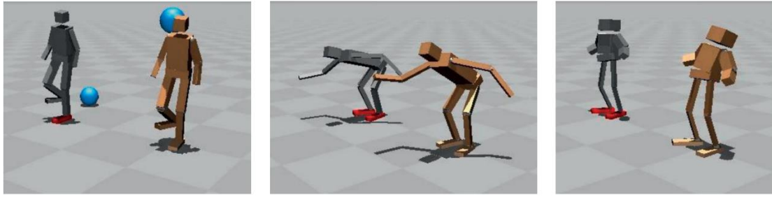
Figure 10-6 : Résultats du contrôle basé physique visant à reproduire un mouvement de référence. (Gauche) Le contrôleur est capable de résister à des perturbations externes. (Milieu) Le contrôleur gère des contraintes physiques comme l'équilibre. (Droite) Le contrôleur gère aussi des changements de morphologies.
