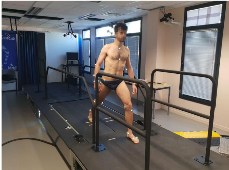
Figure 4-5 : Photographie de l'expérimentation développée par Vincent Gibeaux pendant sa thèse [Gibeaux 2022]. Des sujets montent et descendent d'un tapis roulant en marche, ainsi que réalisent des passages de lacunes de différentes tailles.
