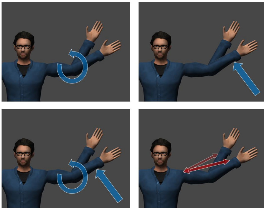
Figure 6-3 : Illustration des principes des 4 actionneurs classiques : les couples articulaires (en haut à gauche), les forces externes (en haut à droite), les forces virtuelles (en bas à gauche) et les forces musculaires (en bas à droite).
