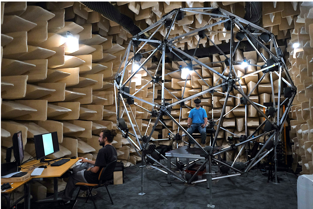
FIGURE A.1 – Photo du système de spatialisation 42 canaux en chambre semi-anéchoïque.
