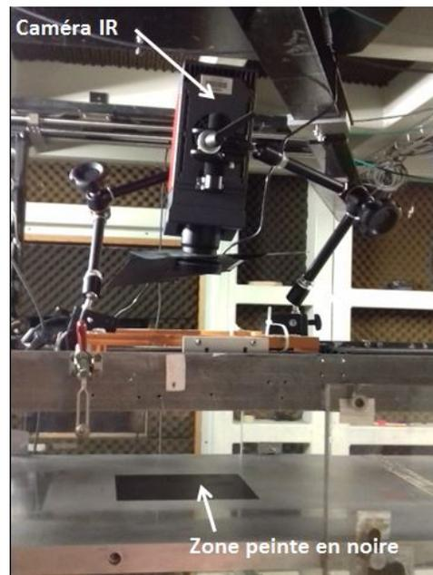
FIGURE 2.16. – Installation de la caméra infrarouge au-dessus de la veine d'essai
