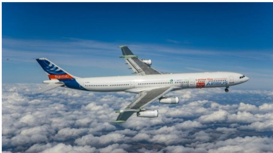
FIGURE 1. – Démonstrateur BLADE équipé de tronçons d'ailes laminaires
