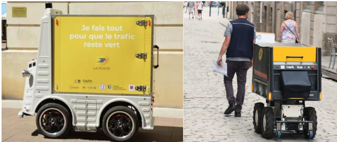
Figure 4 : Chariots suiveurs en expérimentation par La Poste
