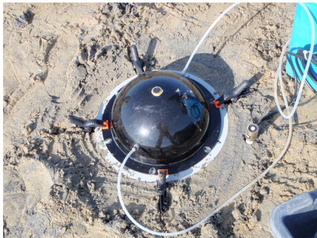
FIGURE 1.4 – Exemple de mesure de la respiration des sédiments à l'aide d'une chambre benthique. Le dôme peut être soit opaque (comme ici) pour la mesure de la respiration, soit transparent pour la mesure de la production primaire nette.
