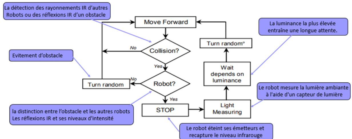
FIGURE 4.16 – Algorithme d'agrégation des abeilles (BEECLUST) [9].
