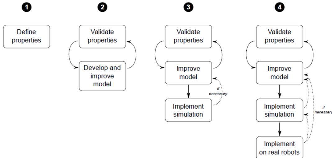
FIGURE 2.6 – Les quatre phases de la méthode property-driven design [22].
