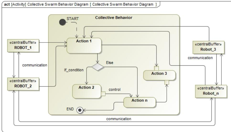
FIGURE 3.7 – Diagramme du comportement collectif de l’essaim CSBD
