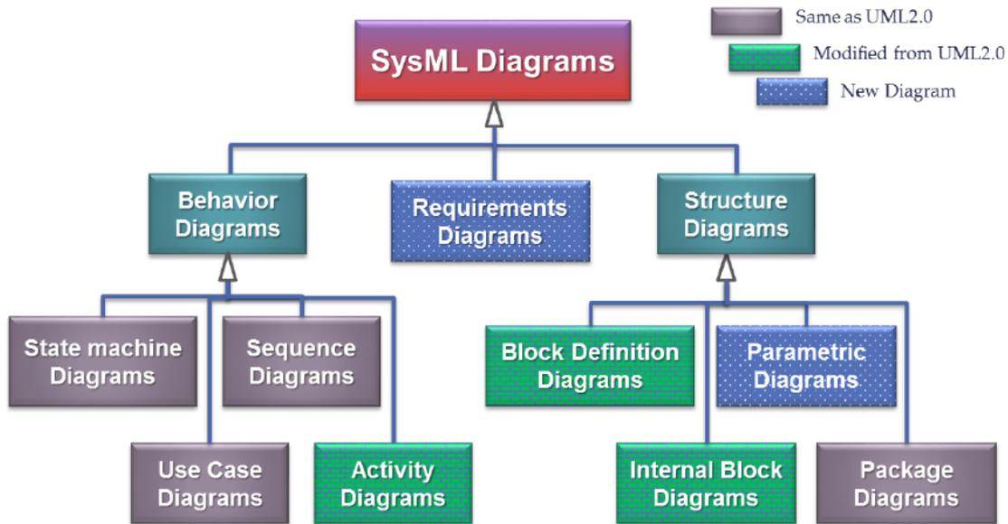
FIGURE 3.2 – Taxonomie des diagrammes SysML [57].
