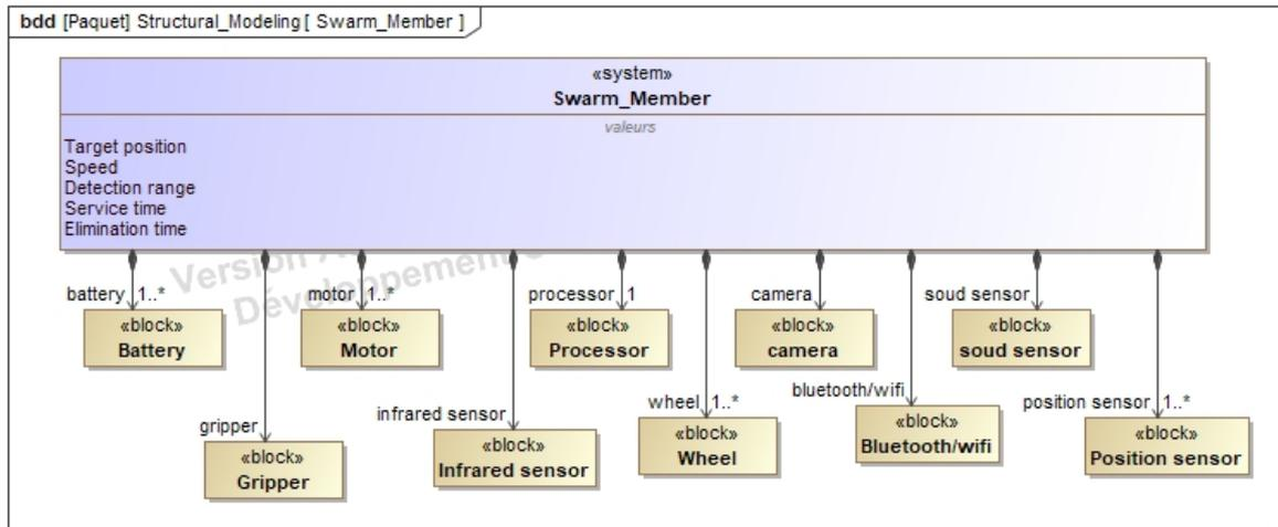
FIGURE 4.14 – Architecture d'un membre d'essaim en SysML.
