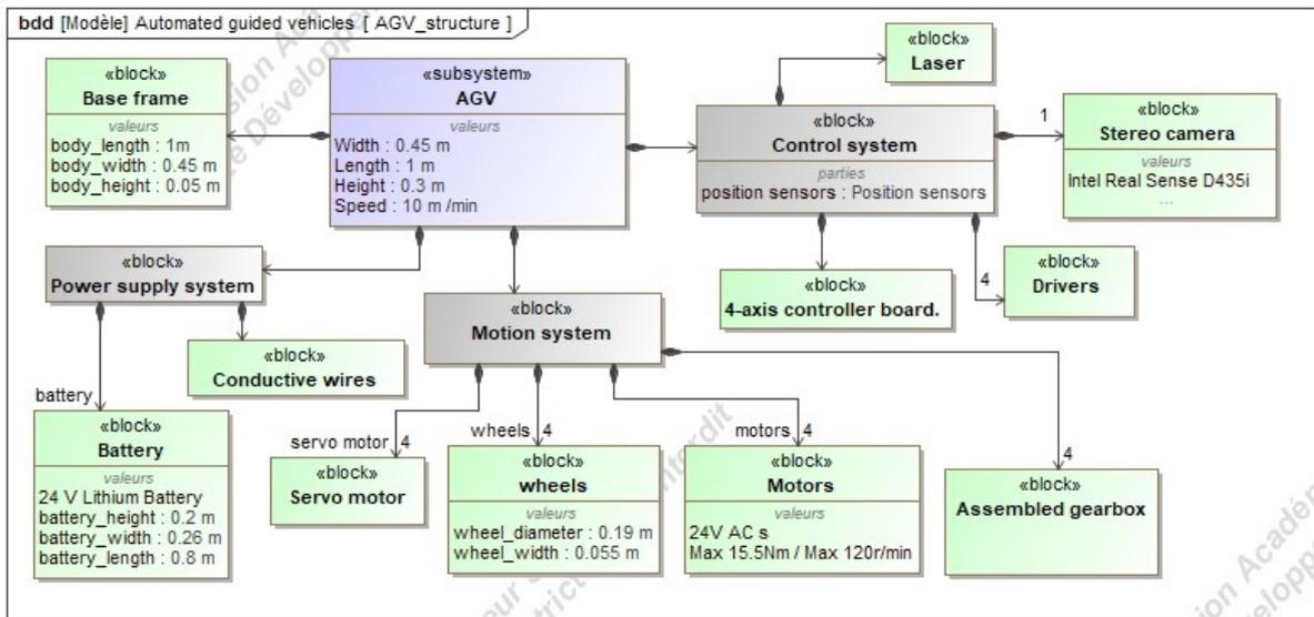
FIGURE 5.6 – L'architecture du système AGV en SysML.
