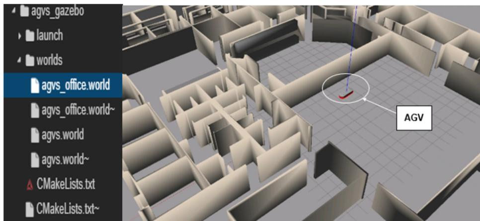
FIGURE 5.13 – Modèle 3D d'une usine dans Gazebo.
