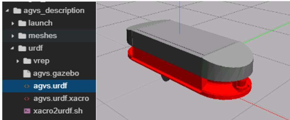
FIGURE 5.12 – Modèle 3D d'un AGV dans un Gazebo.
