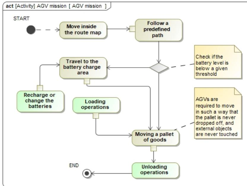
FIGURE 5.4 – Modélisation d'une mission d'une AGV sur SysML.
