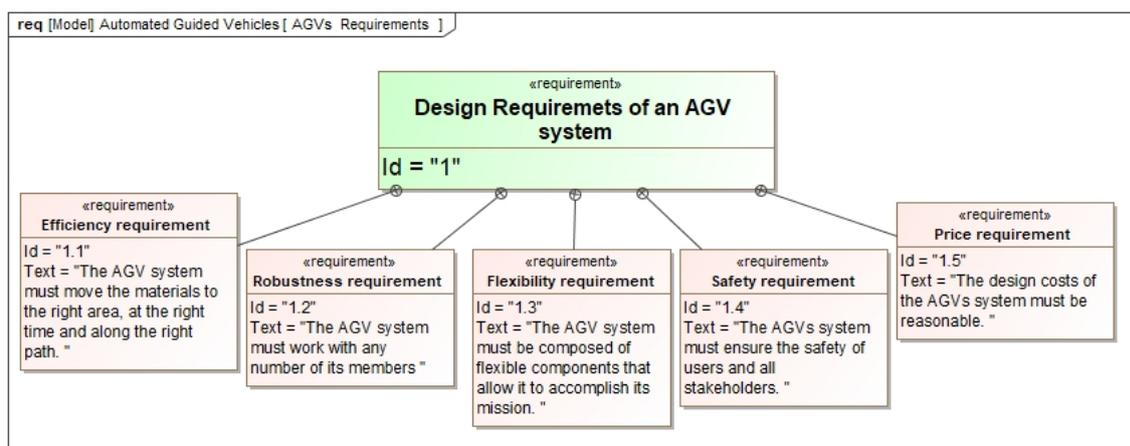
FIGURE 5.1 – Diagramme d'exigences de la conception de l'AGV en SysML
