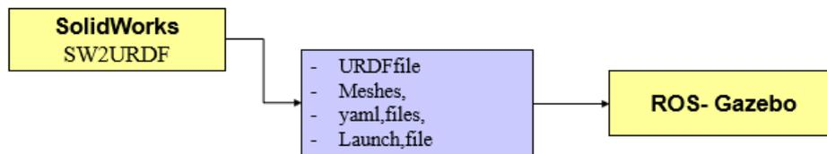
FIGURE 5.10 – Modélisation d'un système AGV de SolidWorks à Gazebo.
