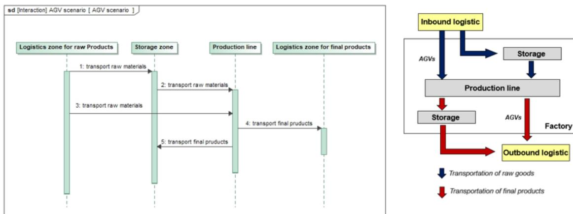
FIGURE 5.3 – Présentation descriptive d'un scénario AGV.
