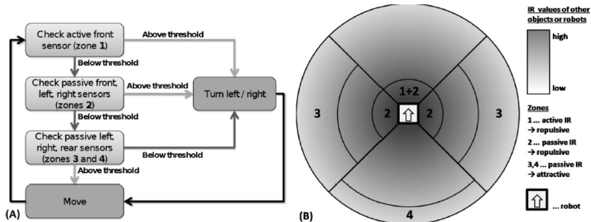
FIGURE 4.15 – A : Architecture de subsomption simple décrivant l'algorithme de flocking. B : Représentation simplifiée des valeurs IR détectées des autres objets [98].
