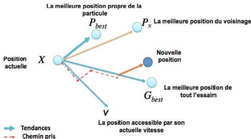
FIGURE 1.2 – Principe de fonctionnement du PSO [138].
