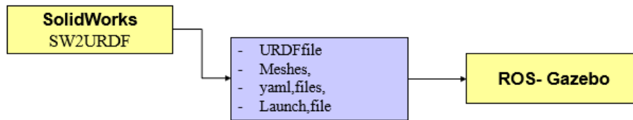
FIGURE 5.10 – Modélisation d'un système AGV de SolidWorks à Gazebo.
