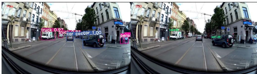
FIGURE 2.2 – Comparaison des performances : YOLOv3 (gauche) et SSD (droite).
