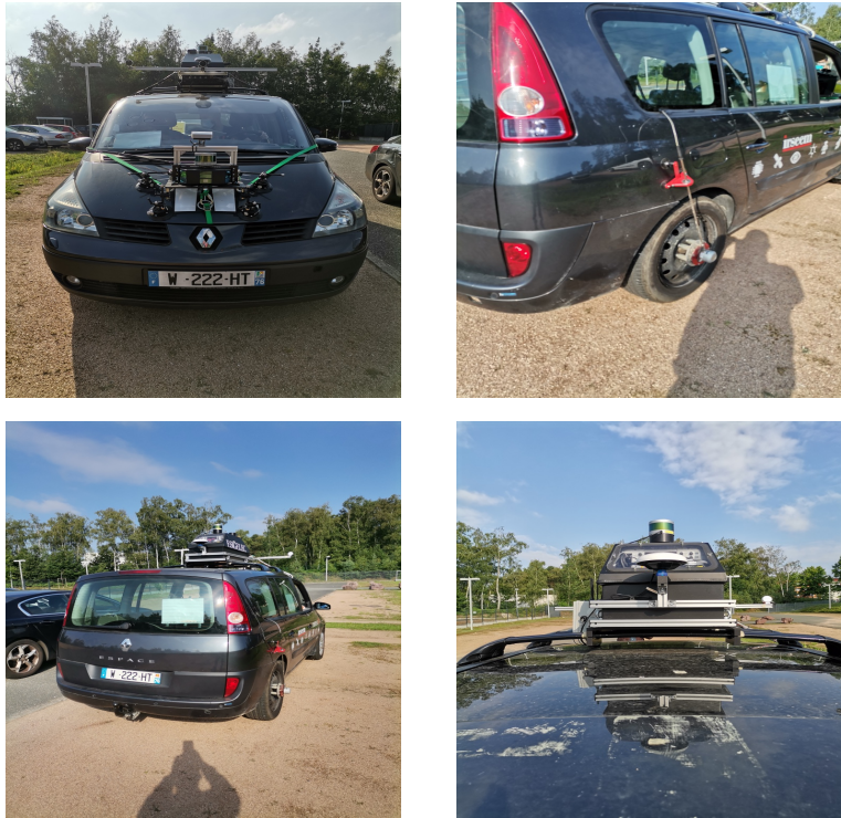
FIGURE 3.2 – Véhicule IRSEEM instrumenté pour la collecte de données. Le coffre sur le toit du véhicule comprend l'ensemble de l'instrumentation (Caméras, GPS/IMU, LiDAR, RADAR, Odomètre).
