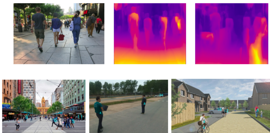
FIGURE 4.2 – Cartes de disparité et estimation de distance. En haut : test de différents jeux de données : cartes de disparité résultantes de l’application de Monodepth sur une scène de trottoir, avec backbone VGG et entraînement sur deux datasets : Cityscape (milieu) et KITTI (droite). En bas : exemple d’estimation de distances. La disparité estimée est superposée à chaque objet détecté.
