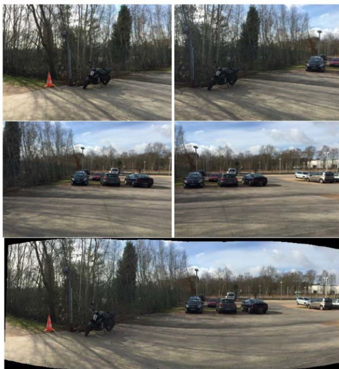
FIGURE 6.2 – Exemple de birdview obtenu à partir de 4 images caméras fish-eye.
