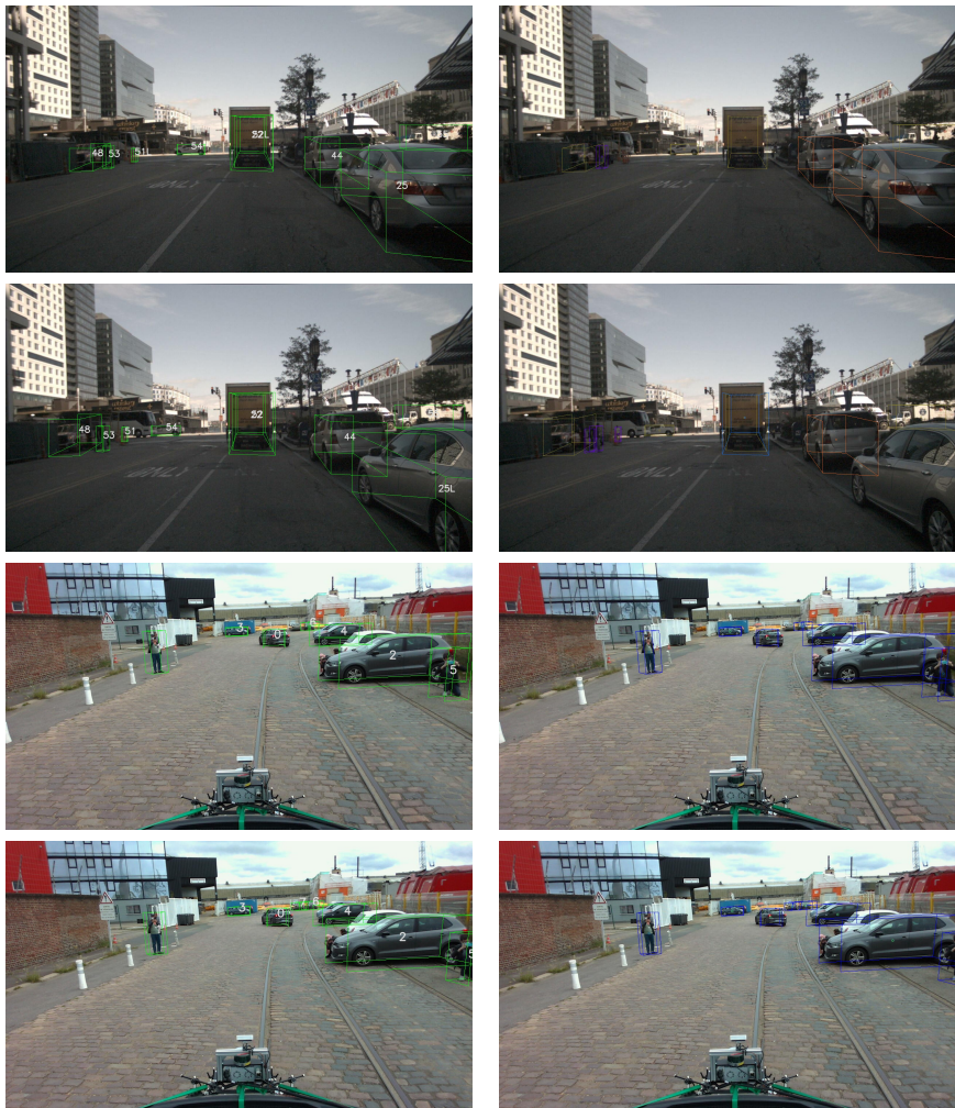
FIGURE 3.13 – Résultats obtenus par notre méthode de suivi d’objets 3D. Les 2 lignes du haut : NuScenes, les 2 lignes du bas : ESRORAD. Le modèle ”Large” entraîné sur NuScenes a été utilisé pour détecter les objets 3D. Dans la colonne de gauche sont présentés les résultats du suivi d’objet avec l’ID de l’objet au centre des boîtes. La lettre L indique qu’un objet est ”perdu”, aucune détection n’a été associée au tracklet mais l’algorithme continue à le suivre quelques images avant de l’effacer. Dans la colonne de droite sont présentés les résultats de notre détecteur d’objets 3D.
