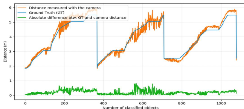
FIGURE 5.4 – Distance mesurée entre les objets correctement classés et la caméra RealSense D435 (orange), distance de vérité terrain (bleu), valeur absolue de la différence entre la distance vérité terrain et celle estimée par la caméra (vert). Les objets détectés sont triés par classe, puis par ordre de détection.
