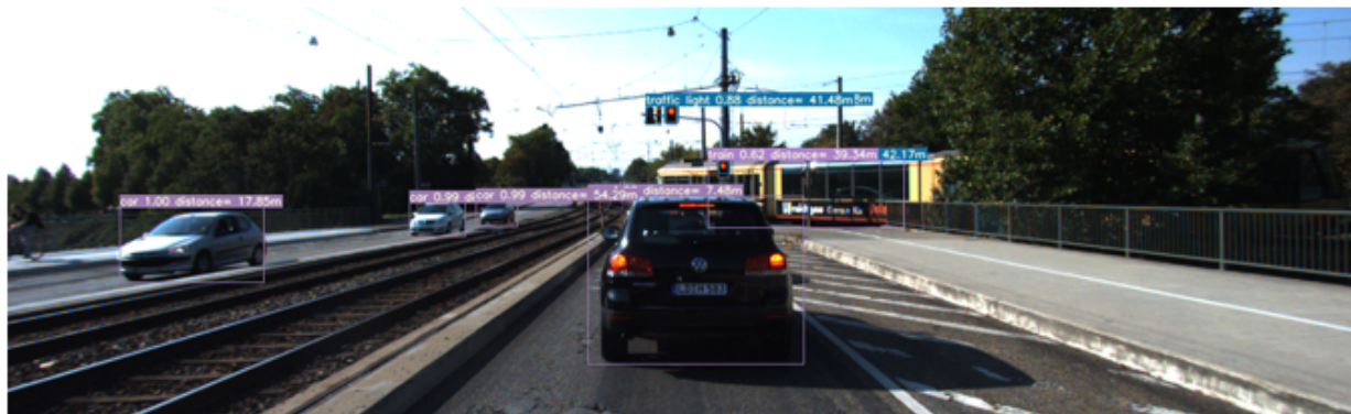
FIGURE 2.5 – Résultats de la détection et localisation d’objets sur un échantillon du jeu de données KITTI.
