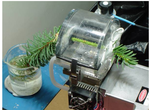
Figure 12 : chambre "conifer chamber" LI-6400-05 utilisée avec l'analyseur LI-6400 (Li-Cor, Lincoln, NE) pour les mesures d'échanges gazeux des tiges. Ici, une tige de l'année d'épicéa ( Picea abies ) dépourvue de ses aiguilles.
