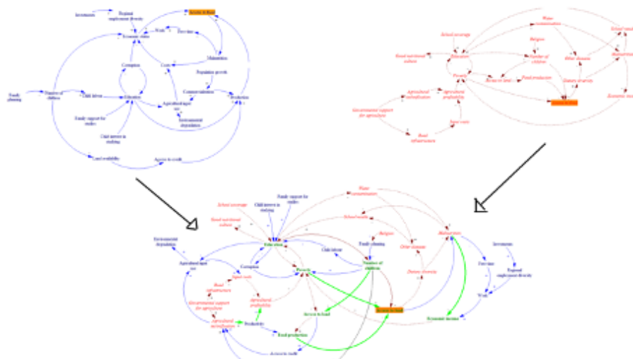
Figure 3.3: Exemple de fusion des diagrammes de boucles causales individuels. Les flèches vertes en gras indiquent les relations présentes dans les deux diagrammes individuels.
