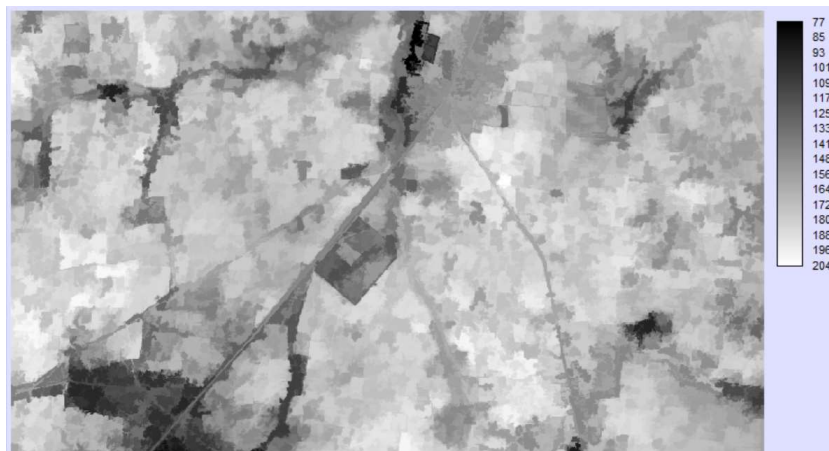
Figure 137 : Résultat des filtres alternés séquentiels par reconstruction (en faisant varier le rayon de l'élément structurant de 5 à 40)
