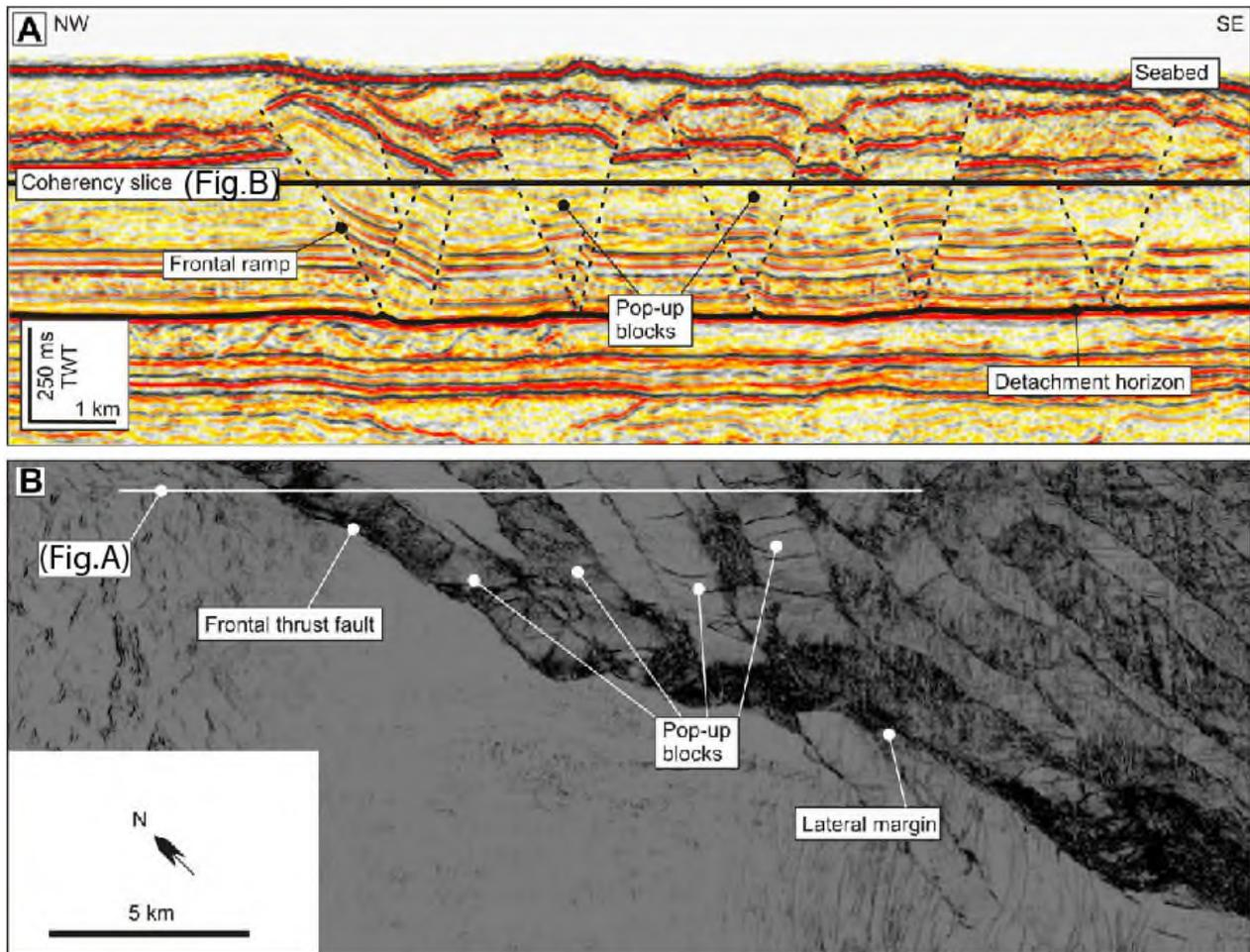
Figure II-21. Exemple en coupe (A) et en carte (B) de systèmes de plis et de chevauchement provenant de la partie frontale méridionale du glissement du Storegga, et présentant des blocs en *pop-up* (d'après Bull *et al.* 2009).
