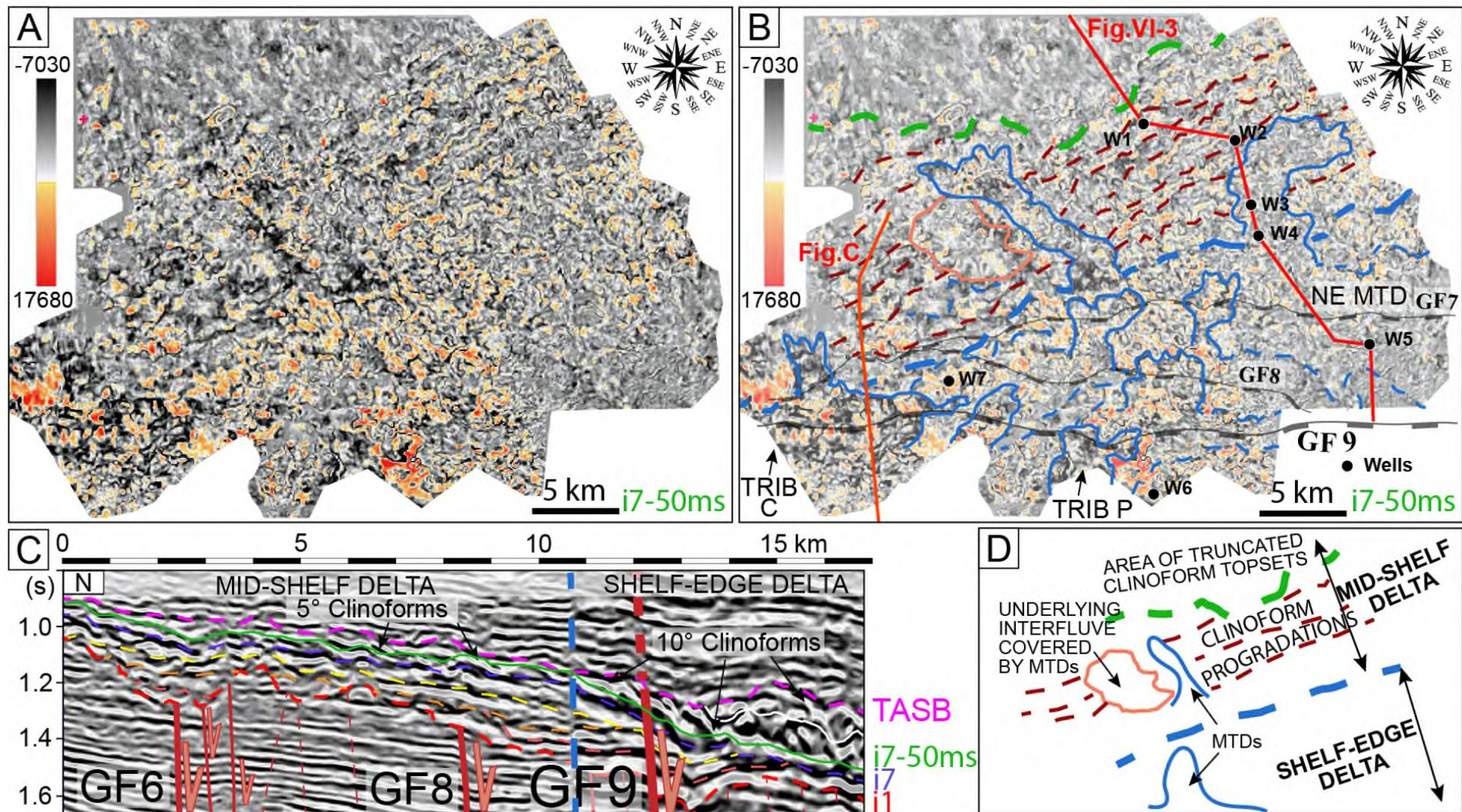
Figure VI-8. A) Carte d'amplitude vierge de l'horizon *i7* traduit à -50 ms. B) Carte d'amplitude interprétée de l'horizon *i7* traduit à -50 ms. C) Section sismique qui illustre le recouplement des clinofomes de la séquence 7 par l'horizon *i7* traduit de -50 ms (en rouge). Le trait vertical bleu correspond à la ligne transition entre le *mid-shelf delta* et le *shelf-edge delta*, induite par l'approfondissement vers le Sud par *i7*. D) Schéma interprétatif.
