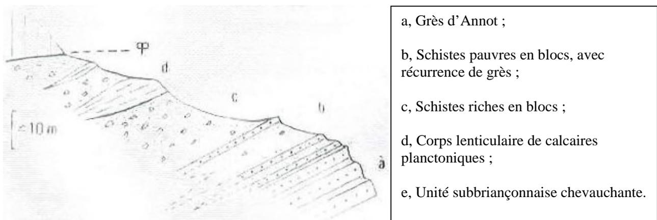
Figure X-1. Lithologie des Schistes à Blocs (d'après Kerckhove, 1975).
