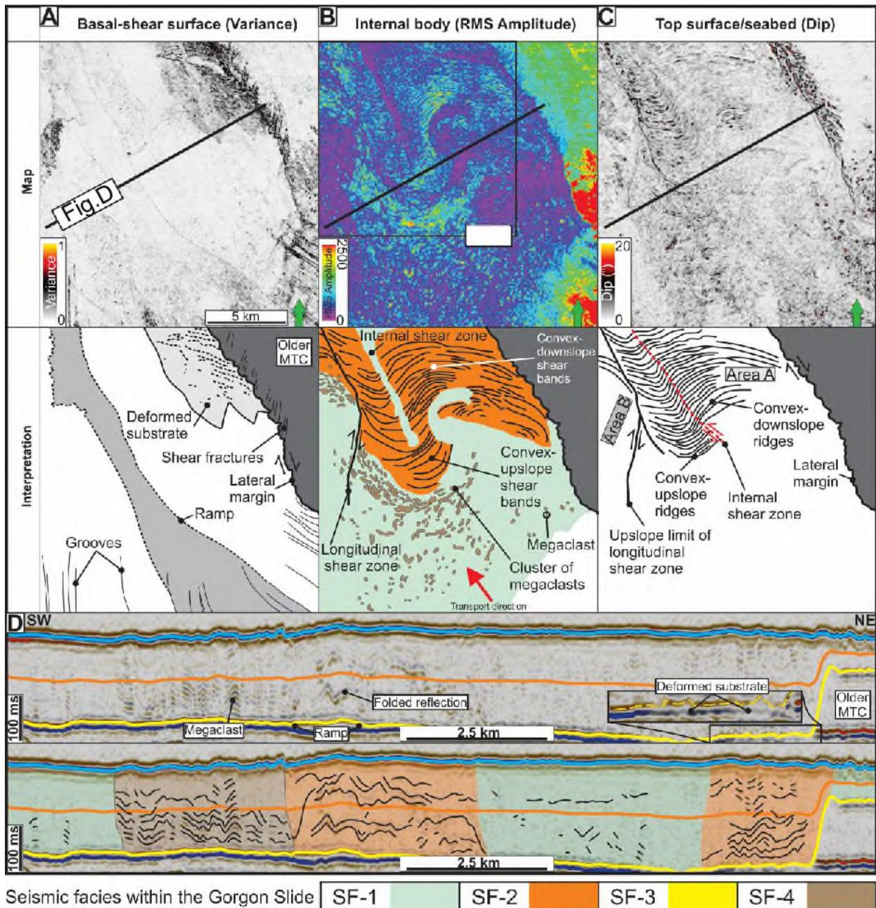
Figure II-17. Différentes cartes d'attributs sismiques et vue en section des zones de déformation longitudinales au sein du glissement Gorgon sur la marge nord-ouest de l'Australie (d'après Nugraha *et al.* 2020).
