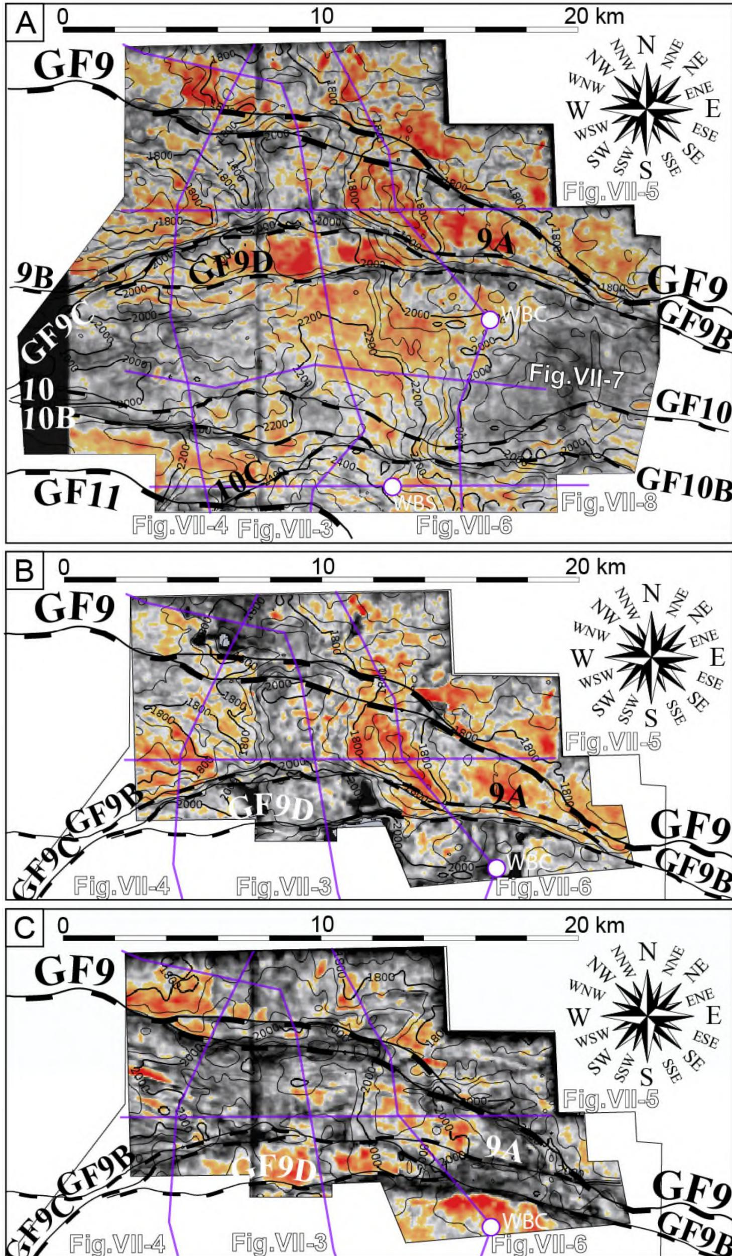
Figure VII-9. (A) Carte d'amplitude minimale à  $\pm 220$  ms (tw) de la base du Canyon Supérieur de Buguma. (B) Carte d'amplitude minimale calculée entre la base du Canyon Supérieur de Buguma et la base du Canyon Inférieur de Buguma. (C) Carte d'amplitude minimale à  $\pm 250$  ms (tw) de la base du Canyon Inférieur de Buguma.
