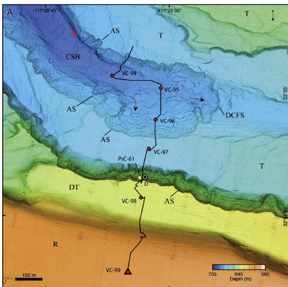
Figure III-6. Morphologies du flanc et du thalweg du Canyon de La Jolla, Californie du Sud (d'après Paull *et al.* 2013). AS, arcuate scarp ; CSB, crescent shaped bedforms ; DCFS, distinctive canyon floor arcuate scarp ; DT, hemipelagic sediment-draped terrace, T, terrace.
