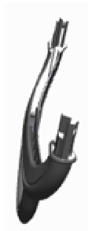
FIGURE 3.6 – Exemple de modèle 3D dont les faces sont à l'envers, ce qui empêche la couleur de s'appliquer correctement et crée un « trou » dans l'objet.
