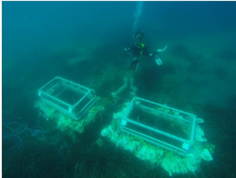
Fig. 21. Photographie sous-marine des deux caissons du système expérimental eFOCE
