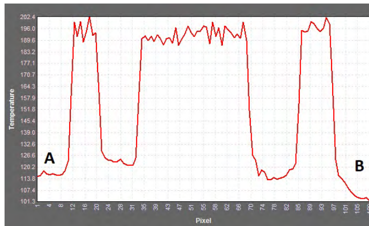
FIGURE 4.19 – Profil thermique sur la ligne longitudinale A-B de la préforme après préchauffage
