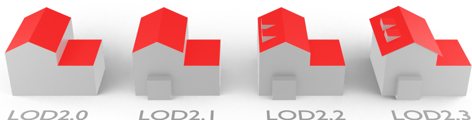
FIGURE 4 – Exemple de modèles de bâtiments LOD2 raffinés de la nouvelle spécification définie par Biljecki et al. [Biljecki et al., 2016c].
