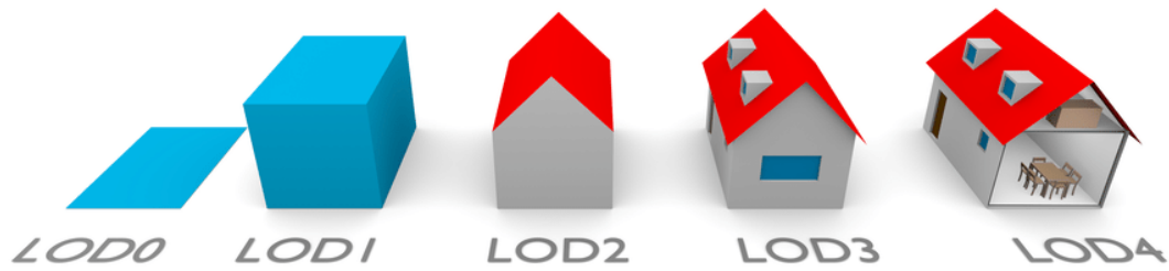
FIGURE 3 – Les cinq LODs de la norme CityGML 2.0. Chaque niveau de détail indique la complexité ainsi que la proximité du modèle à la réalité terrain. Image issue de la thèse de Filip Biljecki [Biljecki, 2017].
