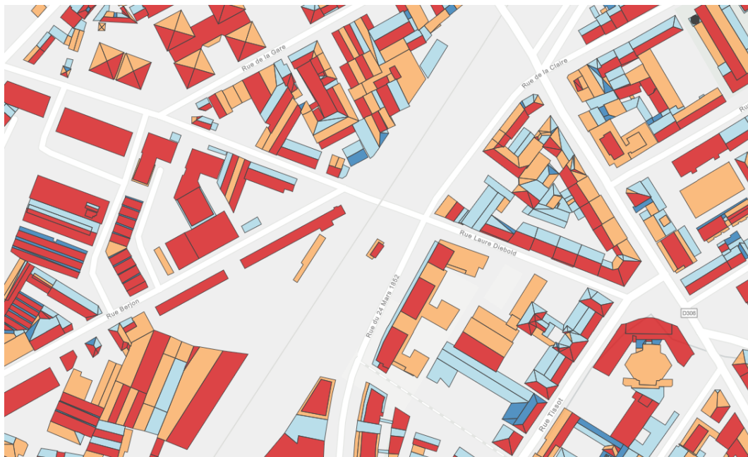
FIGURE 11 – Cadastre solaire calculé avec le logiciel RhinoSolar d’une partie du 9 e arrondissement de la métropole de Lyon, visualisation sur une carte 2D [métropole, 2022b]. Estimation donnée variant de bleu à rouge. Bleu signifie faible exposition solaire, orange, bonne exposition et rouge, excellente exposition.
