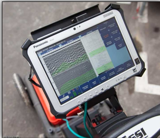
Figure 65 : Affichage sur une tablette des données acquises par un géoradar (source : G. Hulin, Inrap)
