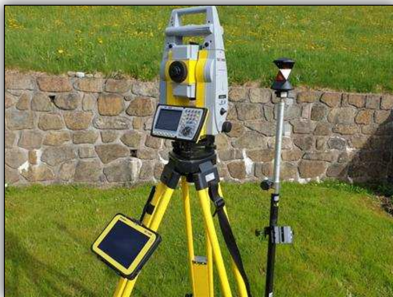
Figure 62 : Tachéomètre robotisé GEOMAX Zoom 90 et sa tablette Panasonic (source : GEOMAX)
