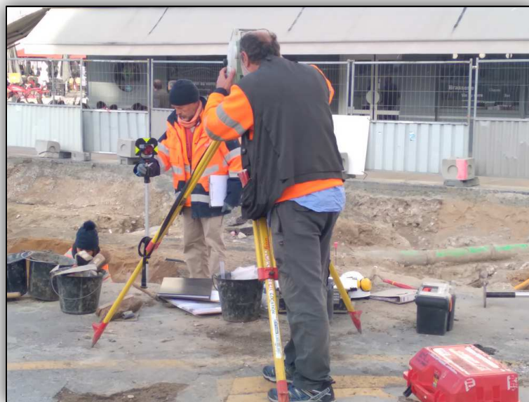
Figure 60 : Levé topographique avec un tachéomètre manuel LeicaTS06 (source : C. Tufféry, Inrap)
