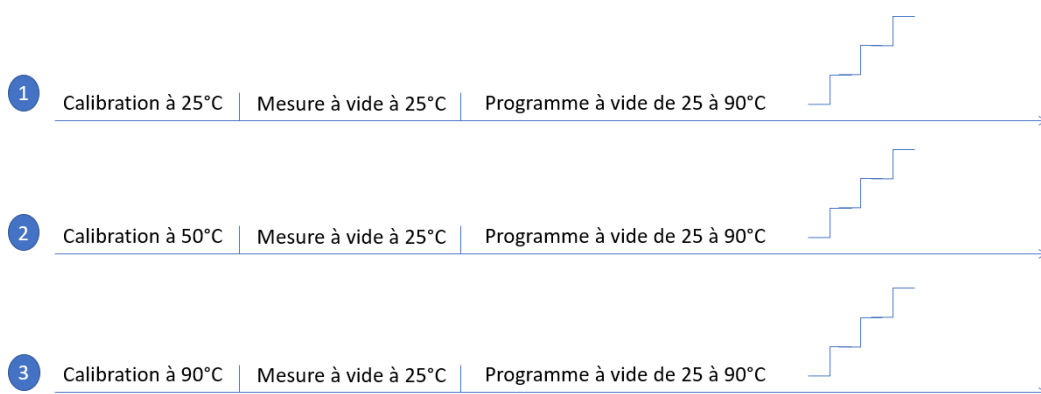
Figure 6. Schéma des protocoles d'essai de calibration à trois températures différentes.
