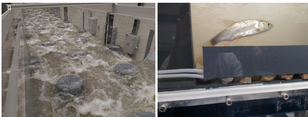
FIGURE 6.1 – Dispositif expérimental pour les tests d'efficacité de franchissement (gauche) et poissons durant les expériences (droite).
