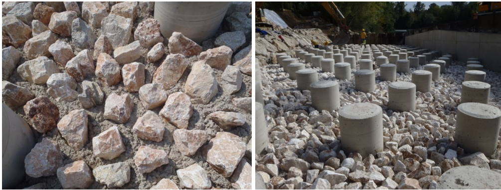
FIGURE 4.48 – Photographies des passes de validation hors d'eau (rugosité de fond de Tabarka et plots à Malhause).
