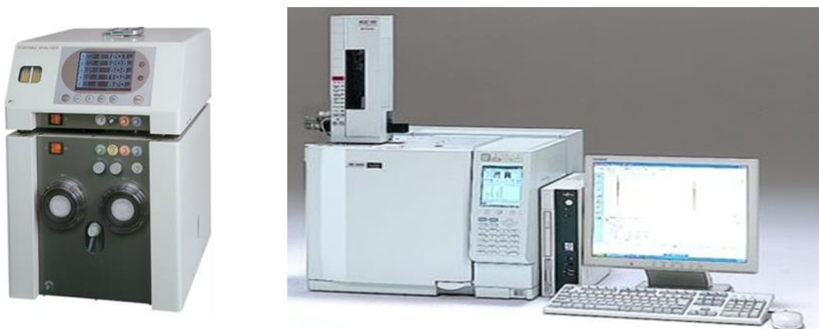
Figure 3 : à gauche) Un analyseur et systèmes d'analyse multi-gaz compact à infrarouge : ZSVS / ZSVF de la société FUJI France, présent dans l'équipe MCI. À droite) Un chromatographe en phase gazeuse et son système d'acquisition et de traitement de données.
