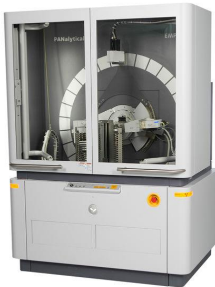
Figure 8 : photographie du diffractomètre à rayonnement X utilisé, Empyrean PANalytical.
