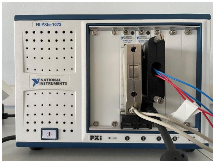
Figure 16 : Châssis PXIe-1073 de la société National Instrument pour piloter des cartes 4140 (SMU) et 4113 (module d'alimentation).
