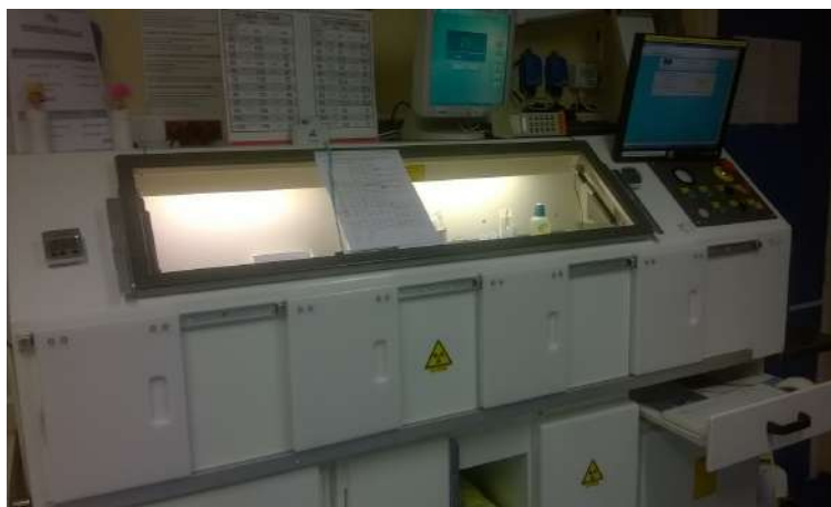
Photo 16 : Enceinte blindée en radiopharmacie (SNL)
