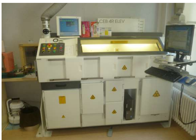
Photo 1 : Enceinte blindée en radiopharmacie (SHD)
