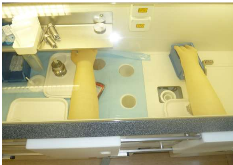
Photo 9 : Intérieur de l'enceinte blindée (SHD)
