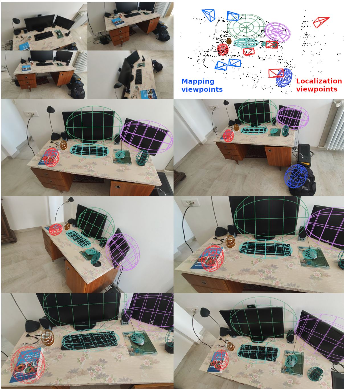
FIGURE 4.22 – Illustration de l’initialisation d’une séquence de localisation à partir d’une carte existante. La carte a été créée à partir de la séquence illustrée par les images en haut à gauche. Les images en dessous montrent les résultats obtenus par notre système en mode « Localisation » par rapport à la carte existante. La bonne adéquation entre les objets dans l’image et les projections de leurs modèles ellipsoïdaux démontre une localisation précise. Des échantillons de points de vue utilisés pour la cartographie sont affichés en bleu dans la carte et ceux de localisation sont affichés en rouge.
