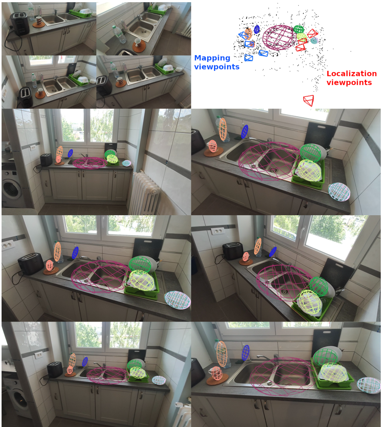
FIGURE 4.21 – Illustration de l’initialisation d’une séquence de localisation à partir d’une carte existante. La carte a été créée à partir de la séquence illustrée par les images en haut à gauche. Les images en dessous montrent les résultats obtenus par notre système en mode « Localisation » par rapport à la carte existante. La bonne adéquation entre les objets dans l’image et les projections de leurs modèles ellipsoïdaux démontre une localisation précise. Des échantillons de points de vue utilisés pour la cartographie sont affichés en bleu dans la carte et ceux de localisation sont affichés en rouge.
