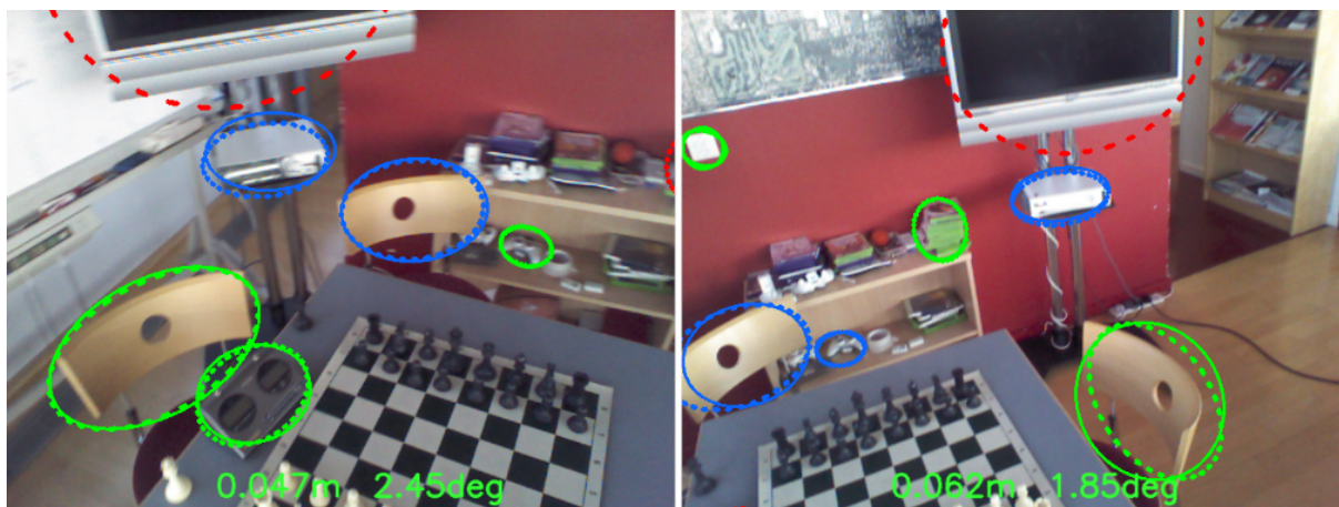
FIGURE 2.52 – Illustration de la pose calculée sur deux images de test de la scène Chess avec l'approche jointe de détection d'objets et prédiction d'ellipses. Les ellipses prédites sont en trait continu et les projections des ellipsoïdes avec la pose estimée sont discontinues. Les ellipses utilisées pour le calcul de la pose sont en vert, celles considérées comme cohérentes dans le processus de validation sont en bleu et les autres sont en rouge.
