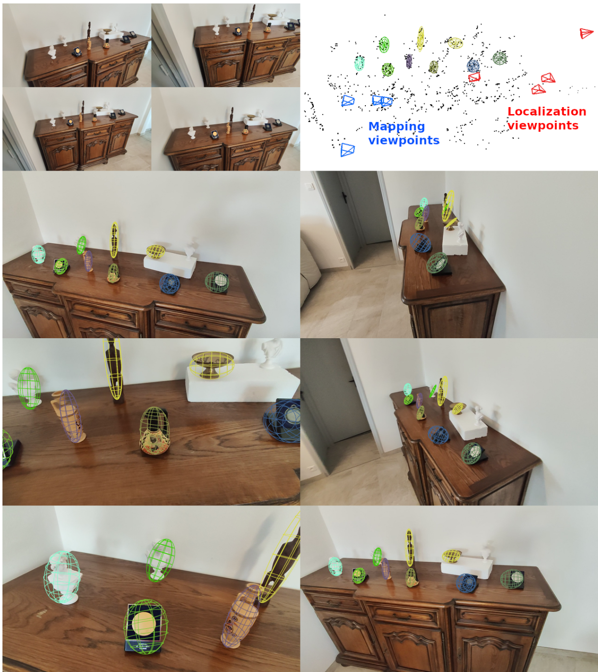
FIGURE 4.23 – Illustration de l’initialisation d’une séquence de localisation à partir d’une carte existante. La carte a été créée à partir de la séquence illustrée par les images en haut à gauche. Les images en dessous montrent les résultats obtenus par notre système en mode « Localisation » par rapport à la carte existante. La bonne adéquation entre les objets dans l’image et les projections de leurs modèles ellipsoïdaux démontre une localisation précise. Des échantillons de points de vue utilisés pour la cartographie sont affichés en bleu dans la carte et ceux de localisation sont affichés en rouge.
