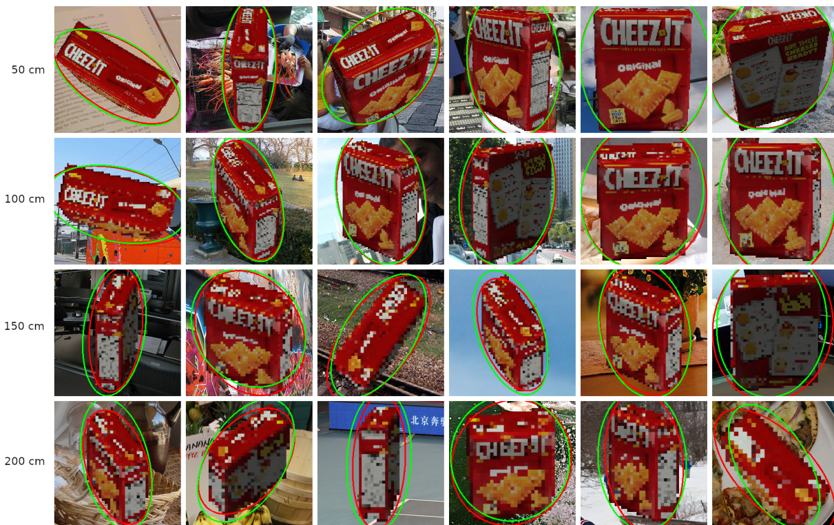
FIGURE 2.27 – Illustrations d'ellipses prédites dans le cas d'un éloignement croissant de la caméra par rapport à l'objet. Les ellipses prédites sont en vert et les ellipses de vérité terrain sont en rouge. On peut noter la baisse de qualité des images avec cet éloignement.
