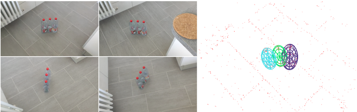
FIGURE 4.14 – La carte reconstruite avec notre système pour trois objets identiques placées côte à côte. Les images sur la gauche donnent un aperçu de la séquence.
