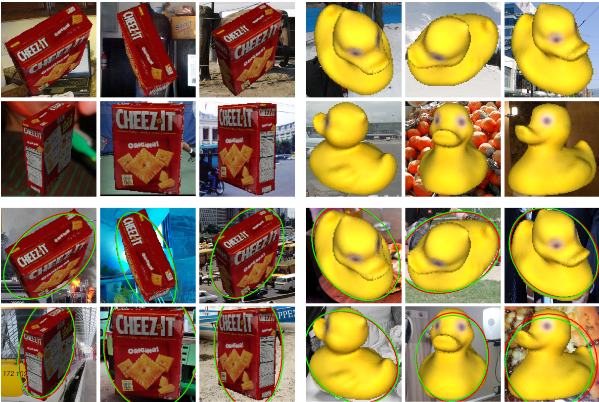
FIGURE 2.22 – Illustration des images d'entraînement synthétiques générées et des prédictions d'ellipses obtenues. Les ellipses prédites sont en vert et la vérité terrain en rouge.
