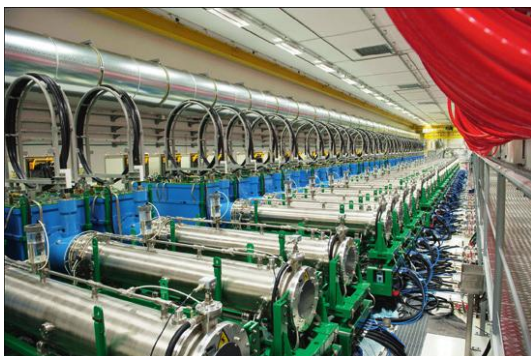
Photo 3 : Générateur de radiographie X éclair (machine AIRIX) au sein de l'installation Epure
