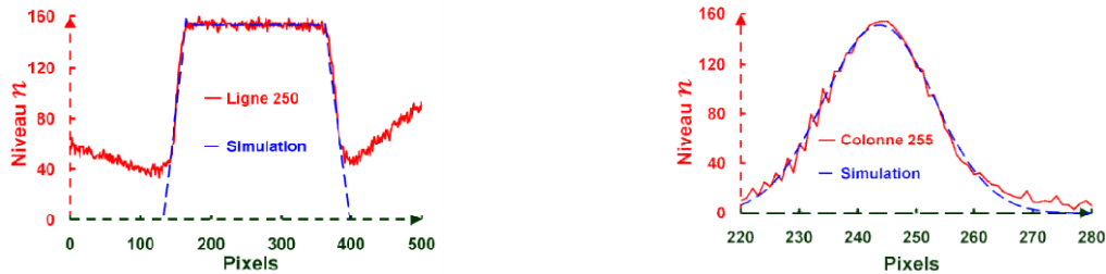
Profil expérimental en horizontale \omega_{1/2} = 2837 \mu\text{m}
