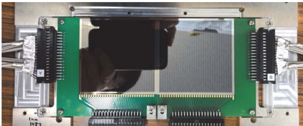
FIGURE 2.20 – Photo du détecteur d’implantation constitué de deux DSSD côte à côte. Photo fournie par K. Morimoto. Picture of the implantation detector composed of two DSSD side by side. Picture provided by K. Morimoto.
