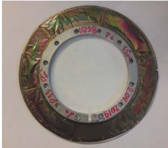
FIGURE 3.7 – Cible d' $^{238}\text{U}$  déposée sur son support de titane montée sur le cadre rotatif.
