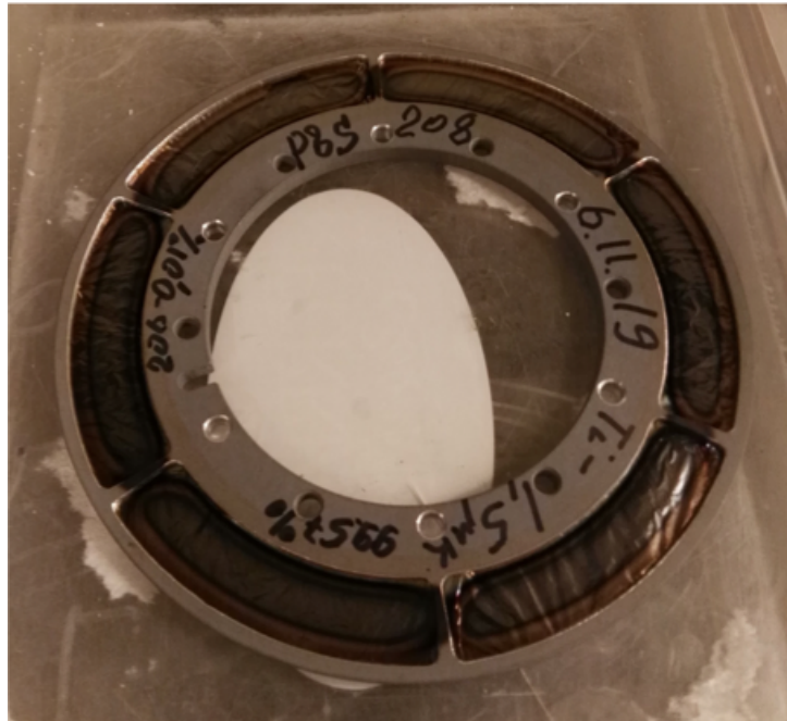
FIGURE 4.4 – Cible de ^{208}\text{Pb} déposée sur un support de titane et montée sur sa roue. Photo prise par Julien Piot.
