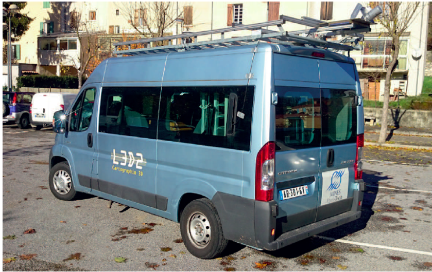
FIGURE 2.14 – Prototype L3D2 version 2018 qui a été utilisé pour produire le jeu de données Paris-Lille-3D
