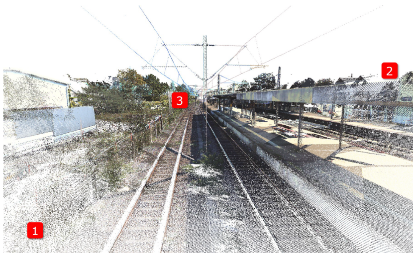
FIGURE 2.36 – Principaux artefacts observables en rendu simple de nuages de points. (1) Problème de remplissage : proche du point de vue, la densité du nuage de points projeté sur l'image est trop faible. (2) Problème d'occlusion : on peut voir à travers le modèle. (3) Problème d'échantillonnage : Aliasing .
