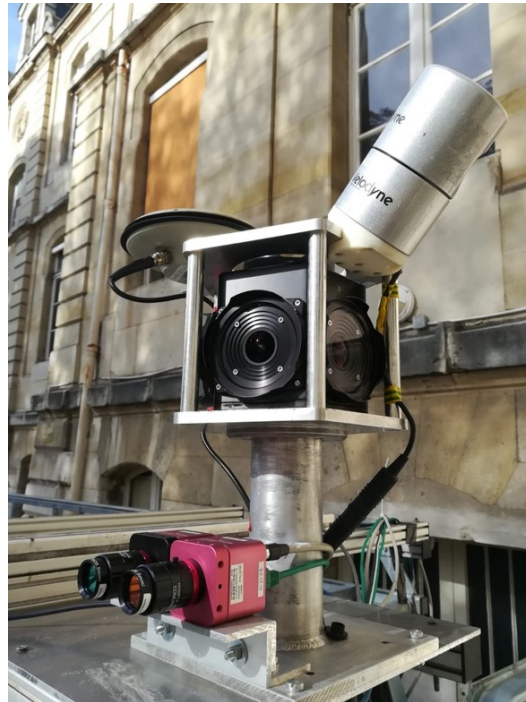
FIGURE 3.1 – Système d’acquisition L3D2 (LIDAR Velodyne HDL32 + caméra Ladybug5) avec de nouvelles caméras hyperspectrales Photonfocus MV1 (VIS 16 bandes + NIR 25 bandes).
