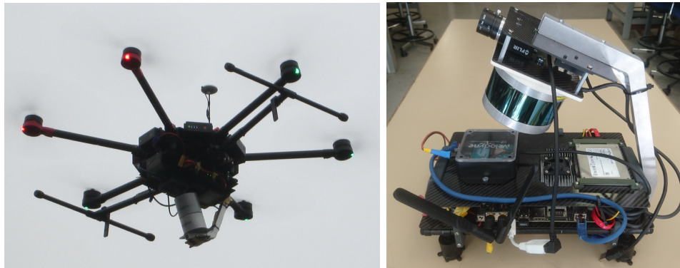
FIGURE 2.18 – A gauche, drone équipé d'un LiDAR Velodyne HDL32 en vol. A droite, plateforme du drone équipée d'un Velodyne VLP16 et d'une caméra FLIR.
