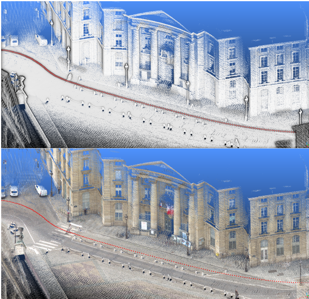
FIGURE 2.23 – Au-dessus, nuage de points produit par IMLS-SLAM avec le LiDAR positionné à l’arrière en mode mapping . Acquisition de la rue Soufflot et du tour du Panthéon avec vue sur la Mairie du 5 ème (trajectoire du système mobile en rouge). En-dessous, même acquisition avec l’ajout de la couleur au nuage de points provenant d’une caméra Ladybug5 (6 caméras dans un seul bloc pour un champ de vue à 360°)
