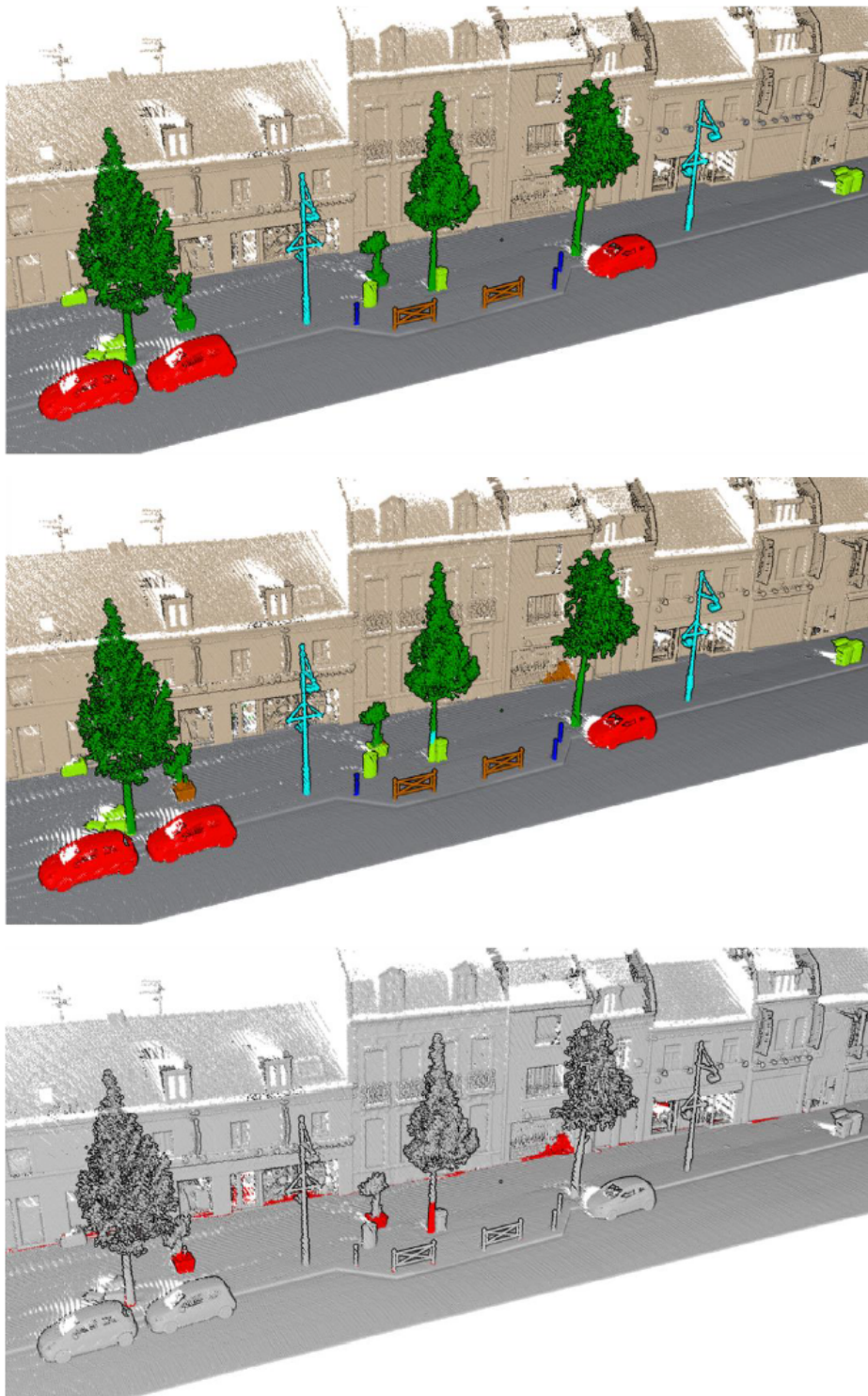
FIGURE 2.35 – Segmentation sémantique du jeu de données Paris-Lille-3D avec KPCConv. Au-dessus, la vérité terrain. Au milieu, la prédiction par KP-FCNN. En dessous, les erreurs de prédiction en rouge.
