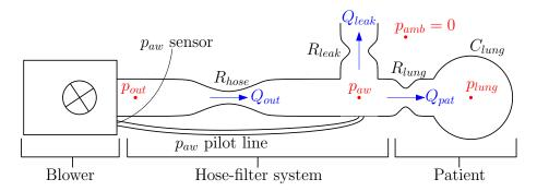
Figure 24: Représentation schématique du système souffleur-tuyau-patient, avec les résistances, la compliance pulmonaire, les pressions et les débits correspondants.
