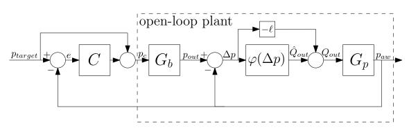
Figure 25: Schéma fonctionnel du système de ventilation complet, avec  $G_b$  la dynamique du ventilateur, C un contrôleur de rétroaction arbitraire,  $G_p$  la dynamique de la fuite du patient, et  $\varphi(\Delta p) = R_{hose}(\Delta p) + \ell \Delta p$  le modèle non linéaire du tuyau.
