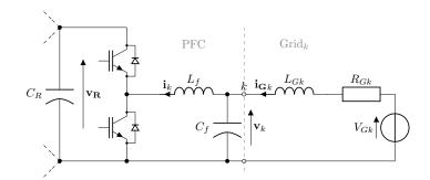
Figure 22: Détail de la k-ième branche du PFC (à gauche) et le modèle de grille de Thévenin proposé tel que vu par cette borne (à droite).
