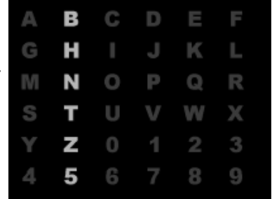
Figure 2.2: Interface cerveau-machine de dictée de lettres. EEG 64 canaux, problème de classification binaire.
