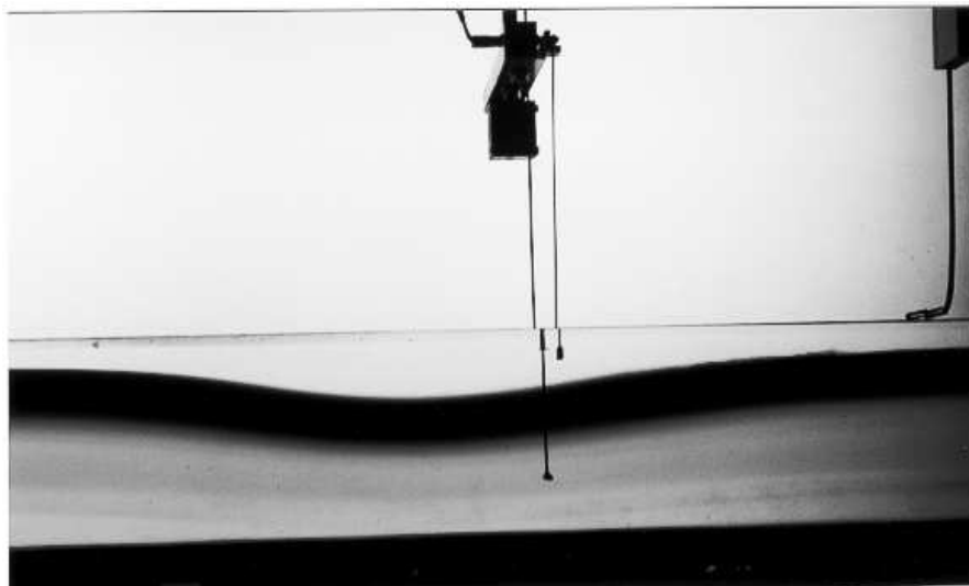
FIG. 6.4 – Photo d'une onde solitaire établie, on peut également observer les sondes de mesures (à ultrasons et résistives) ainsi que sur la droite, le profileur de densité
