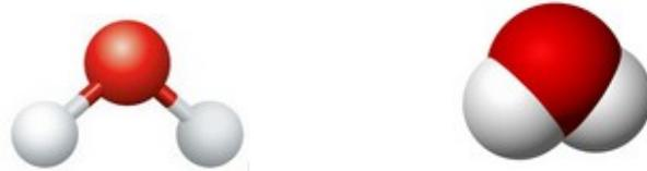
Pour faire de l'hydrogène, il « suffit » de casser les liaisons qui relie les atomes entre eux. Cela peut se faire avec de l'électricité, on fait alors l'électrolyse de l'eau. Les atomes sont détachés et ils se recombinaient différemment : en hydrogène et en oxygène, qui sont tous les deux des gaz. Ce qui est représenté par l'équation :
