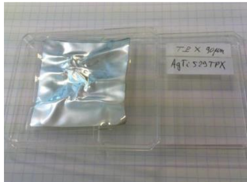
Figure 1-26 : Déformation d'un substrat TPX sous l'effet de la chaleur après un dépôt par pulvérisation [83]
