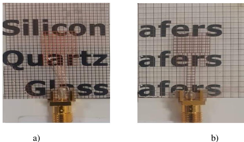
Figure 4-3 : Photographie des antennes grillagées : a) Antenne 2 b) Antenne 3
