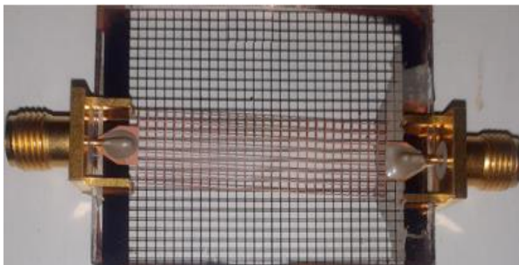
Figure 2-19 : Lignes de cuivre grillagée sur du verre Borofloat 33
