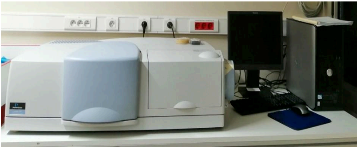
Figure 4-11 : Spectrophotomètre Perkin Elmer lambda 1050 [165]
