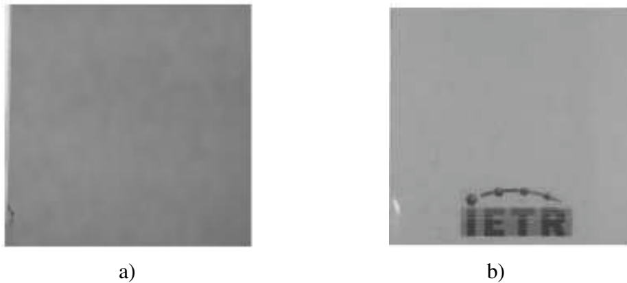
Figure 1-27: Couches de cuivre déposées sur verre Corning 1737 a) Film de cuivre de 1 \mu\text{m} d'épaisseur b) Film de cuivre de 10 nm d'épaisseur
