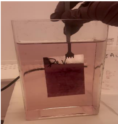
Figure 3-25 : L'échantillon a) dans la solution développeur MF351 b) à la sortie de la solution développeur, dissolution de la résine, motif visible
