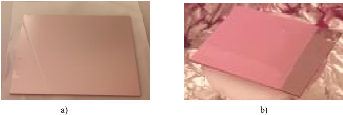
Figure 3-15 : Echantillon : (a) Observation de la couche de cuivre déposé par pulvérisation cathodique magnétron avant électrodéposition, et (b) Observation de la couche de cuivre déposé par pulvérisation cathodique magnétron après électrodéposition
