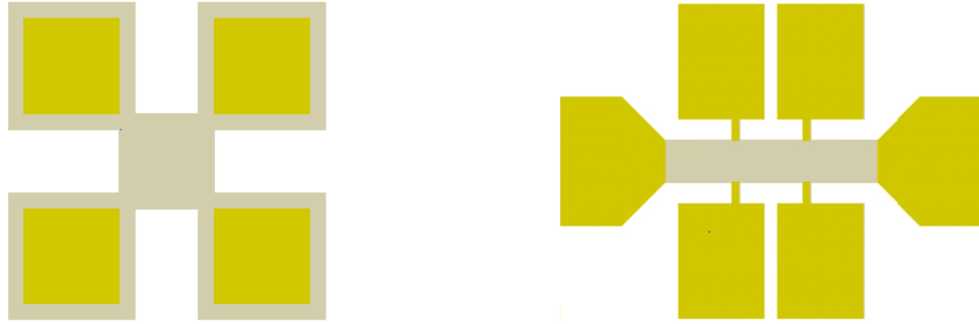
Figure 4.4 : Formes géométriques d'échantillons utilisées pour caractériser les propriétés de transport : forme en trèfle (Gauche), forme en Pont (Droite).
