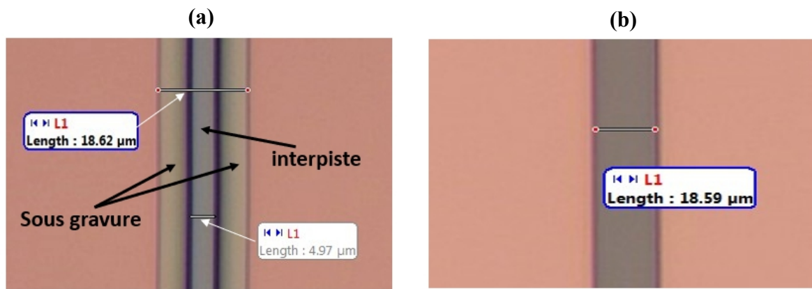
Figure 3.6 : Photos prises au microscope optique : distance entre les motifs avant (a) et après (b) le nettoyage de la résine.
