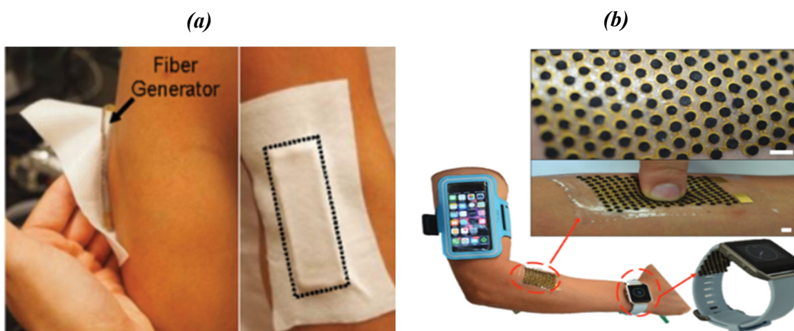
Figure 1.11 : (a) Image d'un textile piézoélectrique fixé sur le coude humain [50], (b) Image de certains dispositifs électroniques fixés sur la peau humaine [51].
