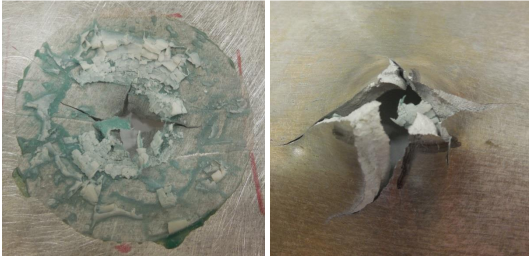
Figure III-47 : Faces avant (gauche) et arrière (droite) d'une protection AM5-AdB250-AA6 impactée par un projectile D6.35-WC-Conique propulsé par le lanceur Ø60 à 830 m/s
