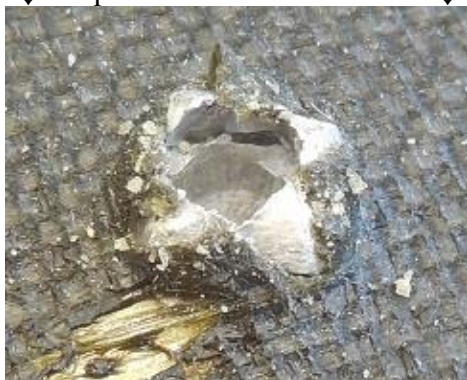
Figure III-40 : Zones impactées d'une protection tricouche AA6-AdC250-TB12 impactée par un projectile D6.35-WC-Conique à 441 m/s avec le lanceur Ø60. Gauche : Faces avant (haut) et arrière (bas) de la plaque avant en alliage d'aluminium. Droite : Faces avant (haut) et arrière (bas) du panneau de tissu balistique arrière.
