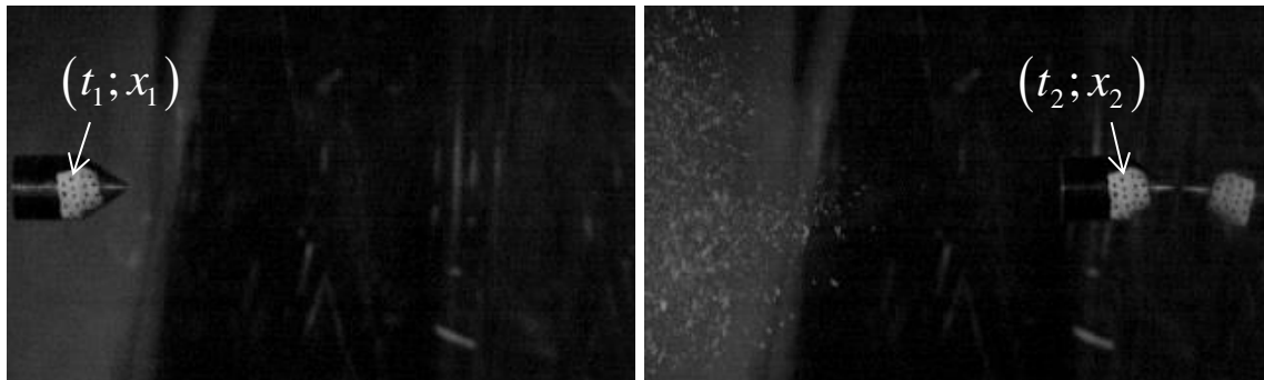
Figure F-1 : Principe de mesure de vitesse en utilisant des images de caméra rapide. Le projectile D20-Acier-Conique est en partie recouvert de mouchetis (points noirs sur fond blanc) et se déplace de gauche à droite
