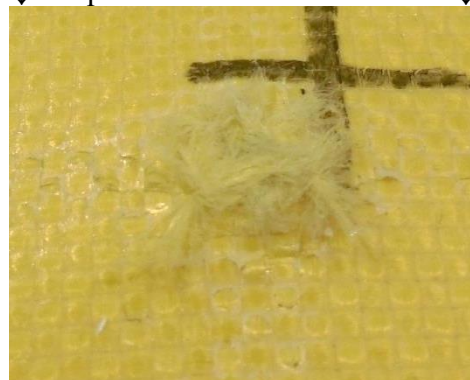
Figure III-40 : Zones impactées d'une protection tricouche AA6-AdC250-TB12 impactée par un projectile D6.35-WC-Conique à 441 m/s avec le lanceur Ø60. Gauche : Faces avant (haut) et arrière (bas) de la plaque avant en alliage d'aluminium. Droite : Faces avant (haut) et arrière (bas) du panneau de tissu balistique arrière.
