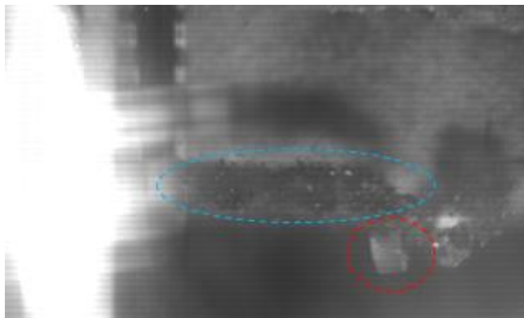
Figure III-32 : Image d'une caméra rapide lors de l'impact d'un projectile de D6.35-WC-Plat impactant une protection tricouche AA6-air10-AA6 à 487 m/s avec le lanceur Ø60. La pastille éjectée est entourée en rouge, et les débris de sabot et d'alliage d'aluminium issus de l'impact sont entourés en bleu. Le projectile, non visible ici, se déplaçait de la gauche vers la droite. La cible, à gauche de l'image, est masquée par un intense flash lumineux.
