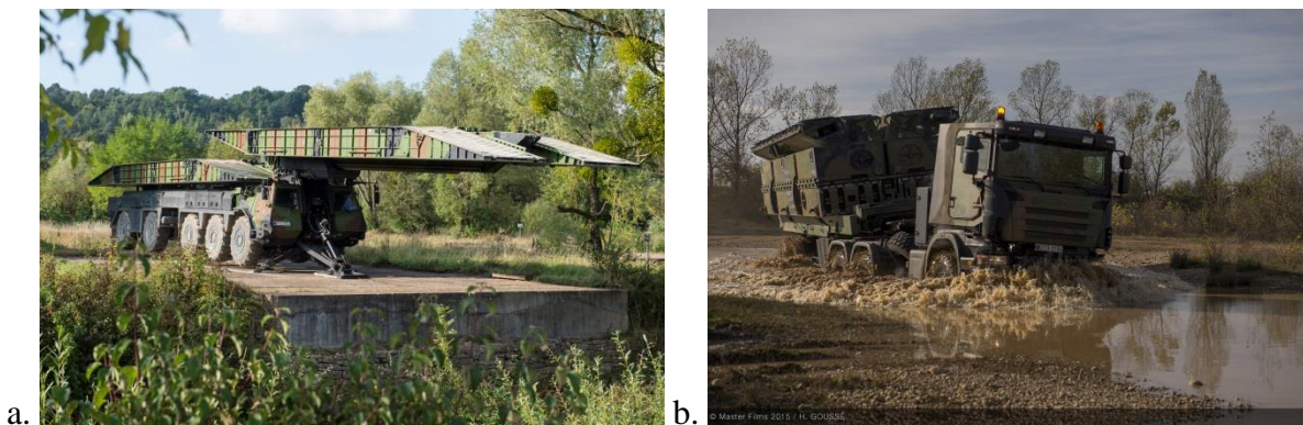
Figure I-1 : a. PTA de CNIM. b. Un module PFM sur semi-remorque CNIM
