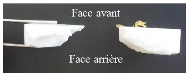
Figure III-46 : Fragments d'alumine mettant en évidence une rupture en forme de cône
