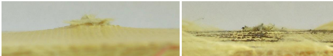
Figure III-42 : Faces arrières des panneaux de tissu balistique dans la configuration AA6-AdC250-TB12 (à gauche, impacté par un projectile D6.35-WC-Conique à 441 m/s) et dans la configuration TB12-AdC250-AA6 (à droite, impacté par un projectile D6.35-WC-Conique à 452 m/s) avec le lanceur Ø60. Vue de profil pour faire ressortir les différences de déformation résiduelle.
