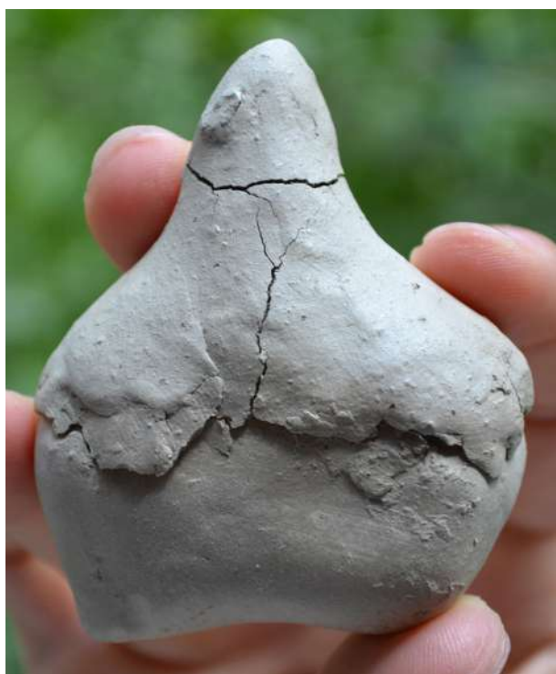
Figure 40 Exemple d'assemblage par adhésion raté (exemplaire expérimental)
