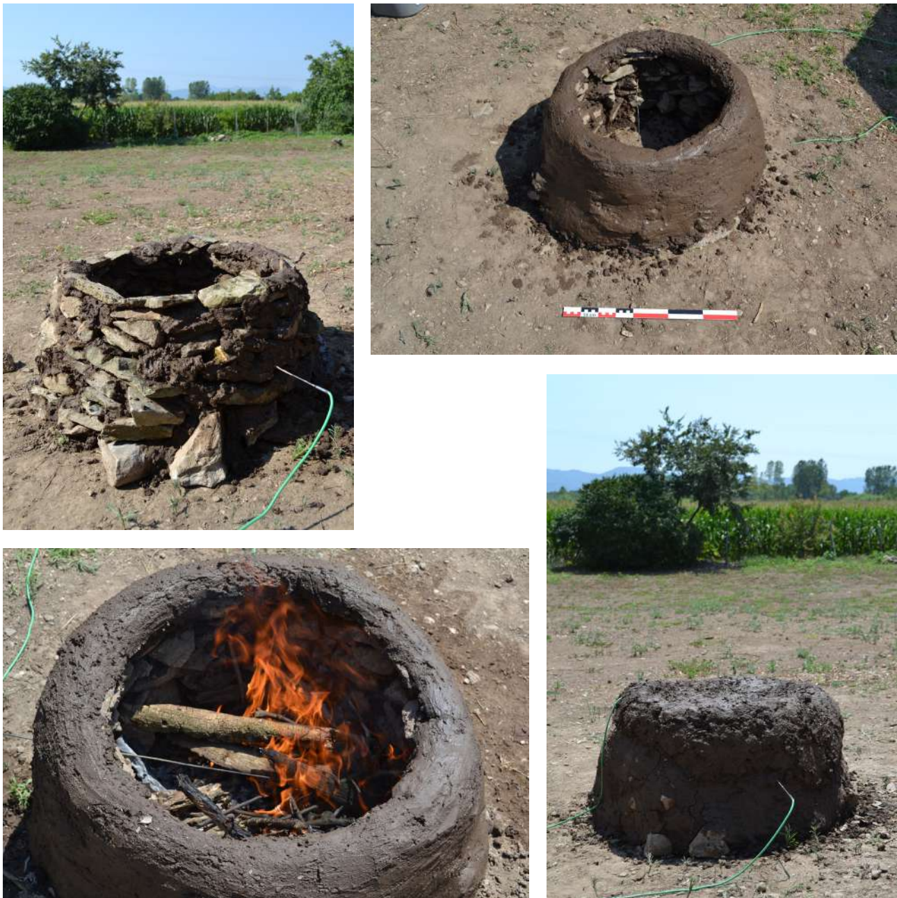
Figure 80 Structure expérimentale de cuisson
