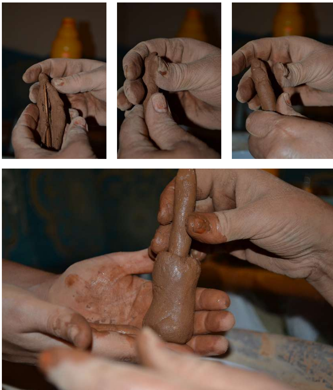
Figure 95 Modelage sur âme d'un pilon de mortier (Douar Ouaraben, région de Tiznit, 2013)
