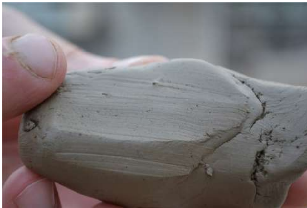
Figure 68 Expérience de lissage « précoce »
