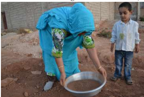
Figure 87 Séparation des éléments grossiers par gravitation (Douar Ouaraben, région de Tiznit, 2013)
