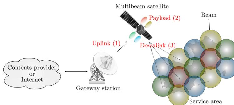
FIGURE 8.4 – Architecture standard d'un satellite de télécommunications multifaisceaux.
