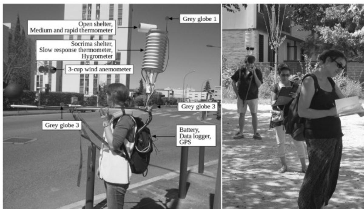
**Figure 13.** Description du protocole instrumental pendant le projet EUREQUA. Structure portable pour les mesures de micrométéorologie (à gauche) et enquête itinérante (à droite) (source : Lemonsu et al. 2019)
