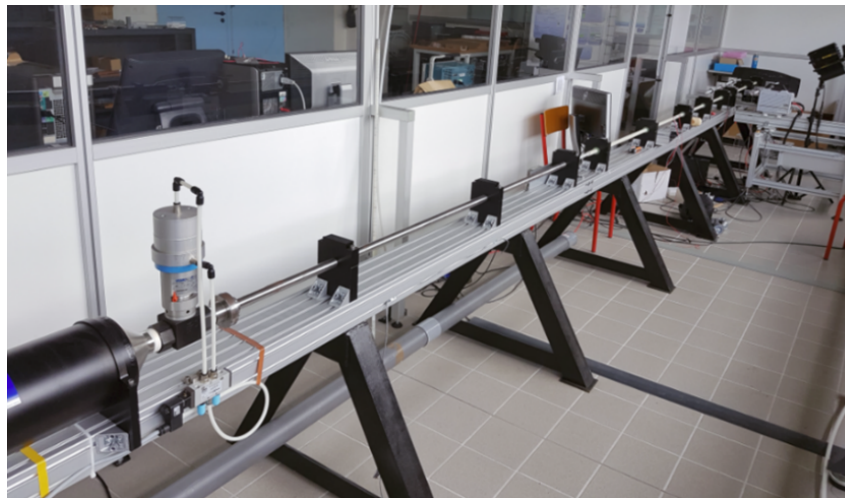
FIGURE 3.8 – Barres de Hopkinson en nylon du LaMé (INSA CVL)
