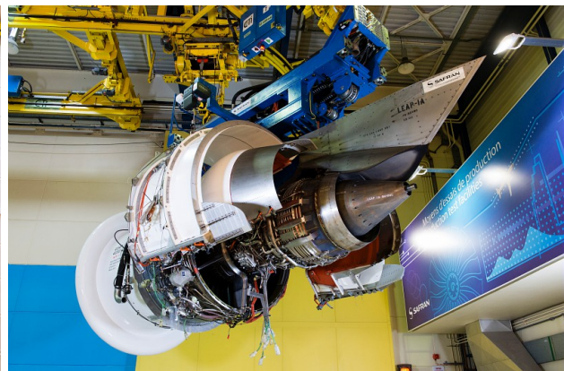
(b) Nacelle et tuyère (source : Safran Aircraft Engines)
