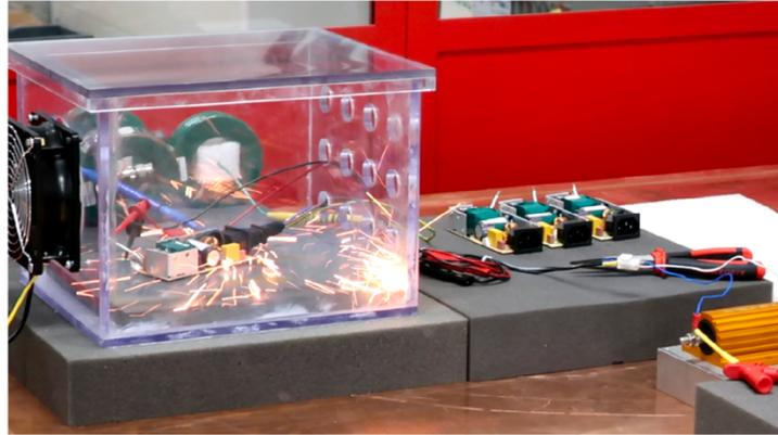
Figure 127 : Destruction d'une alimentation soumise à une impulsion électrique de fort niveau.
